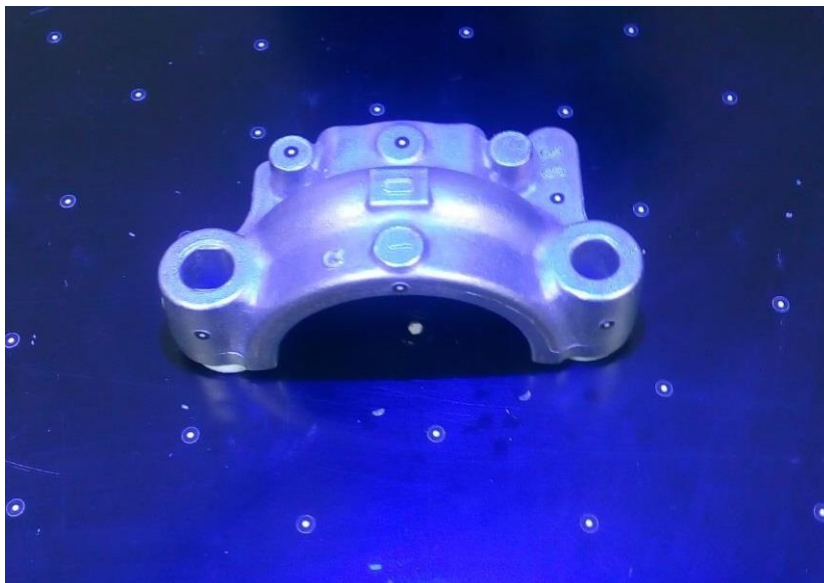
Slika 3.5 Pripremljen komad za skeniranje
