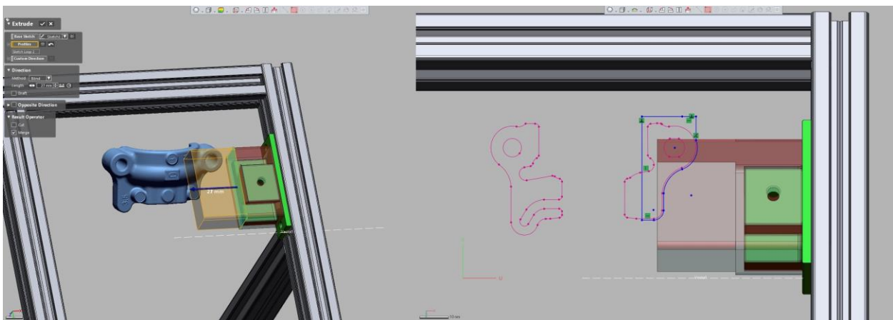
Slika 4.4 Ekstrudiranje i aproksimacija geometrije pomoću presjeka
