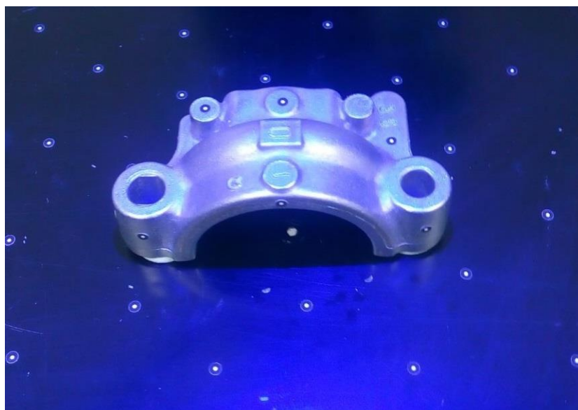
Slika 3.5 Pripremljen komad za skeniranje
