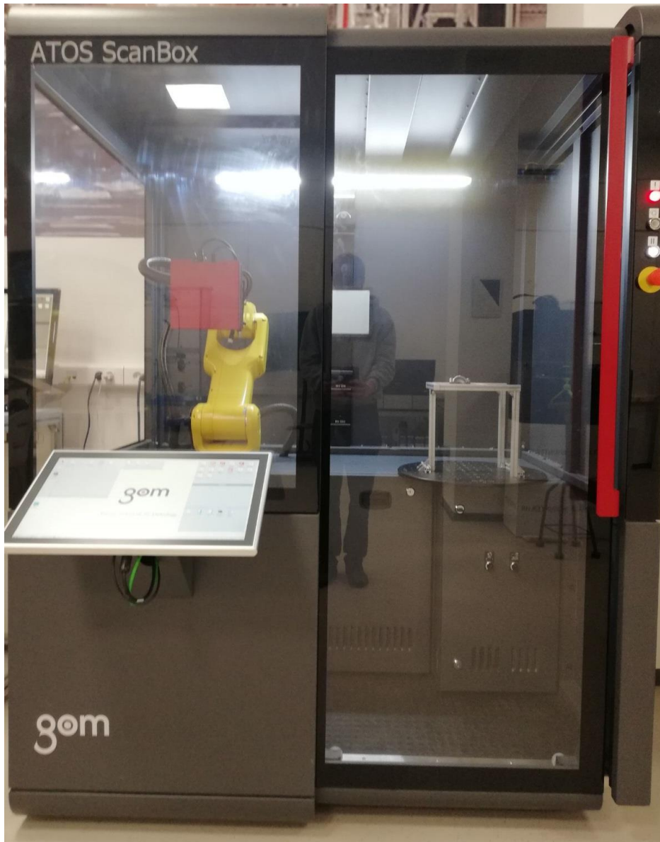
Slika 4.8 Postava za mjerenje u ATOS ScanBox 4105
