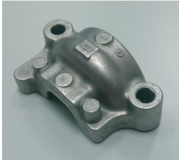
Slika 3.1 Odljevak pokrova kugličnog ležaja
