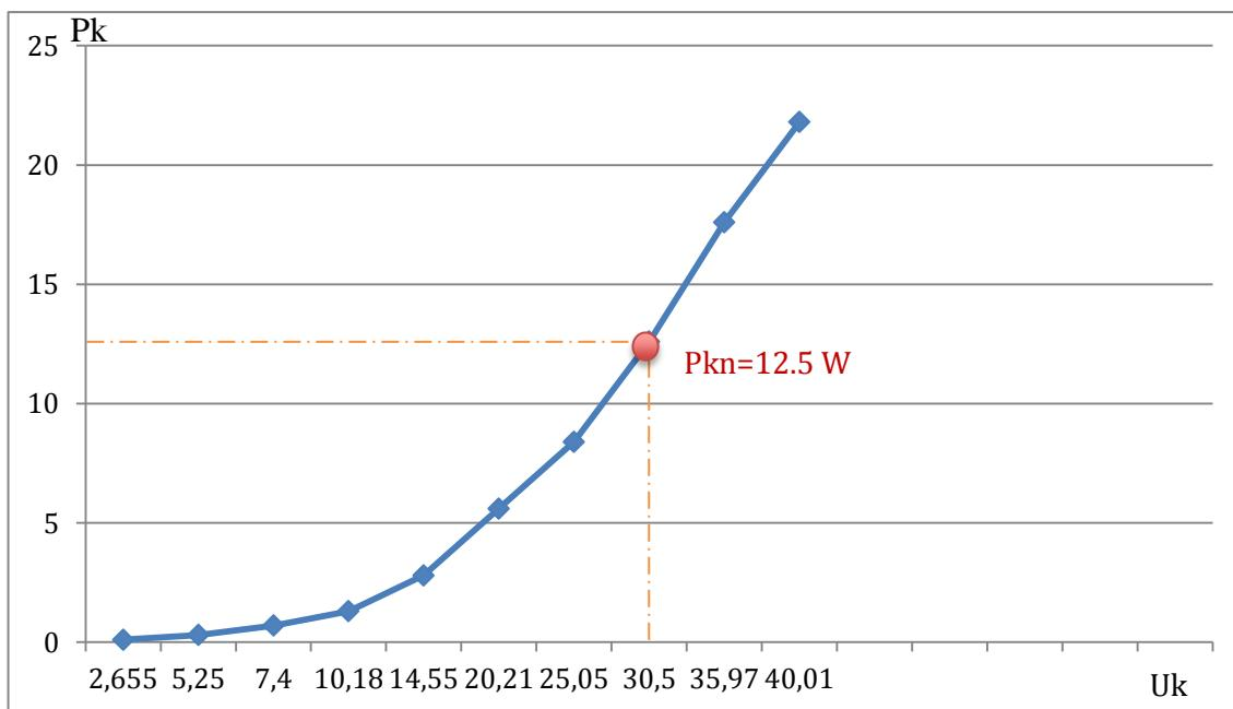
Slika 3.1.3. Krivulja ovisnosti snage o naponu kratkog spoja
