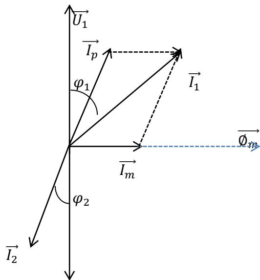
Slika 2.3.3. Vektorski dijagram opterećenja idealnog transformatora [2]
