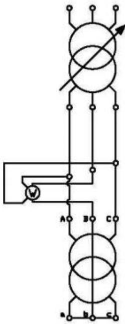
Slika 3.1.1. Shema kratko spojenog transformatora
