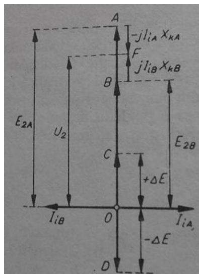
Slika 2.9.1.2 Paralelni rad transformatora
