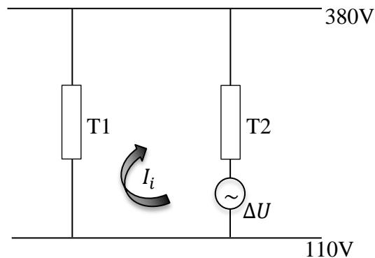
Slika 3.2.1 Dva transformatora spojena u paralelu [5]
