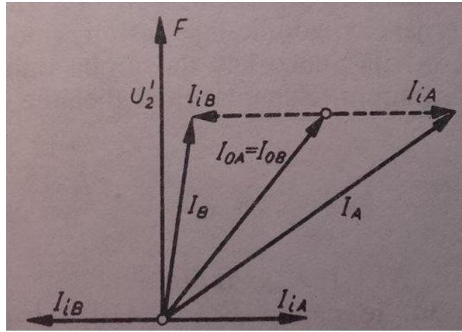
Slika 2.9.1.3 paralelni rad transformatora
