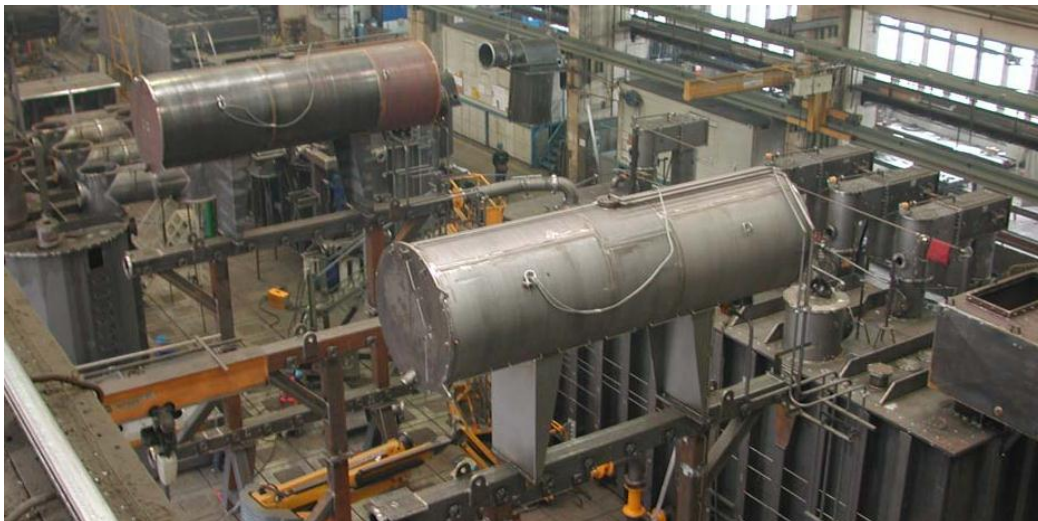
Slika 2.8.4.1 Prikaz izrade konzervatora u tvornici Končar [6]
