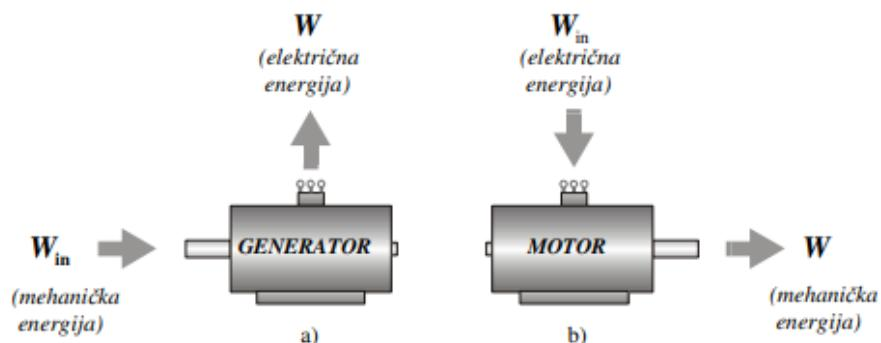
Slika 1.1. Pretvorba energije u električnom stroju
