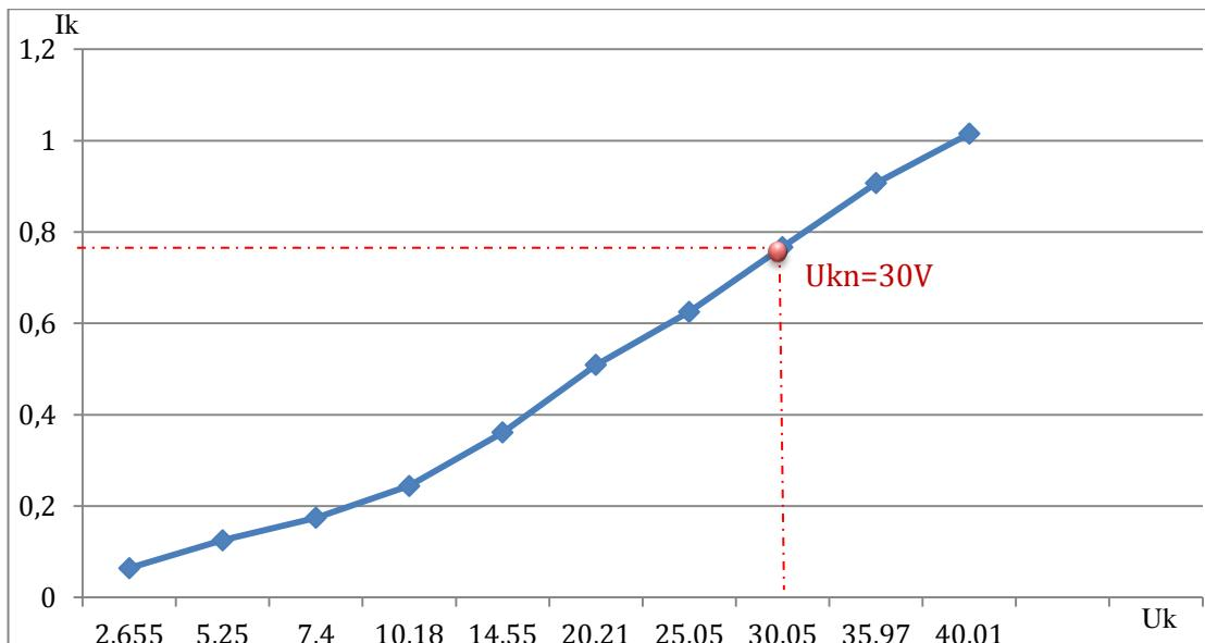
Slika 3.1.2. Krivulja ovisnosti struje kratkog spoja o naponu kratkog spoja
