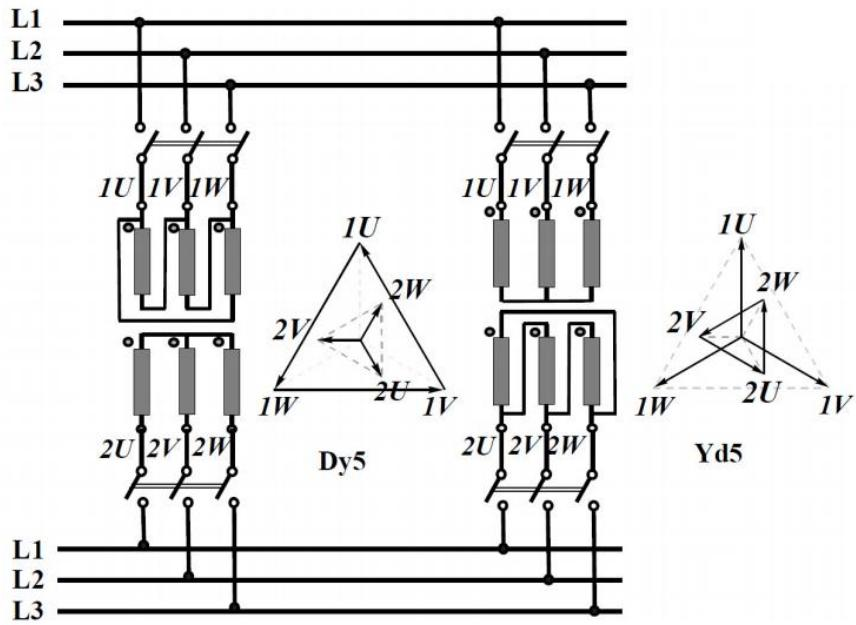
Slika 2.9.1 Paralelni rad transformatora Dy5 i Yd5 [5]
