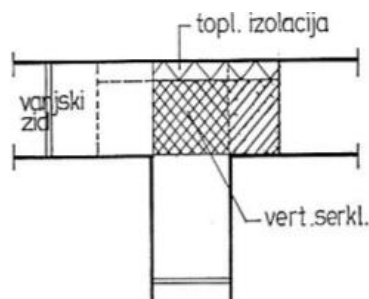
Slika 3.9. Vertikalni serklaž na spoju sa zidom
