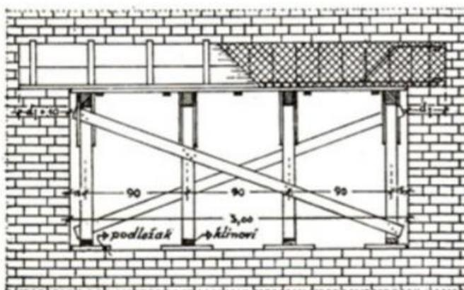
Slika 3.14. Prikaz skele i oplata nadvoja, uzdužni presjek
