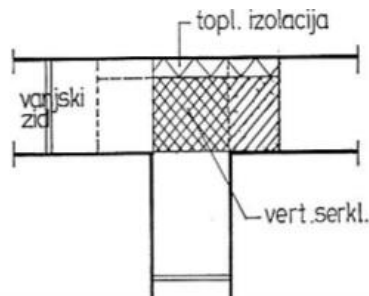
Slika 3.9. Vertikalni serklaž na spoju sa zidom
