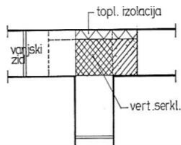
Slika 3.9. Vertikalni serklaž na spoju sa zidom
