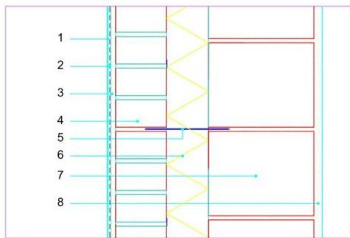
Slika 7.2. Toplinsko izolirani vanjski zid s obzidnom opekom
