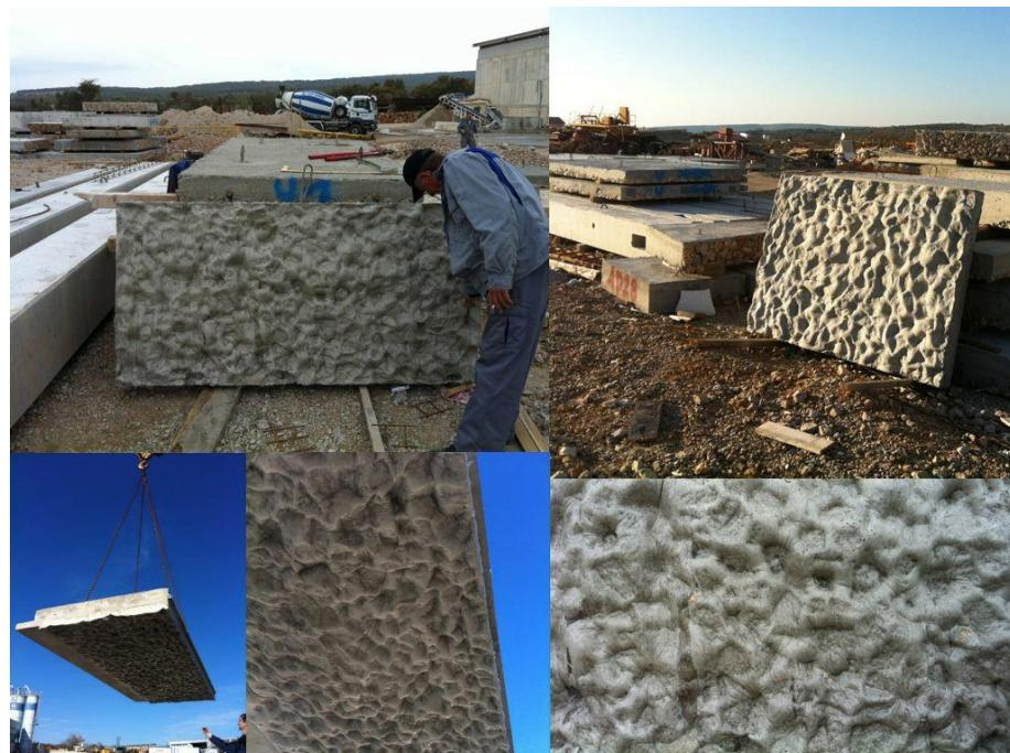
*Slika 7.3. Armiranobetonski prefabrikati*
