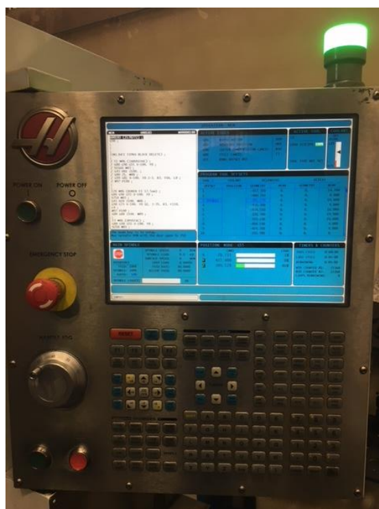
Slika 2.10 Upravljačka ploča Haas VF-3YT glodalice [8]
