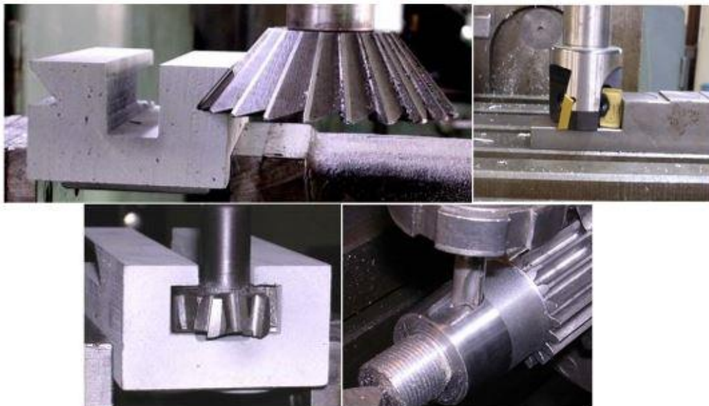
Slika 2.6 Postupci glodanja vertikalnom glodalicom [6]
