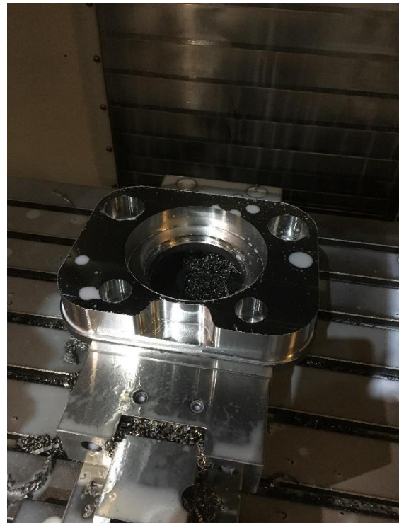
Slika 8.6 Glodanje vanjske konture [8]
