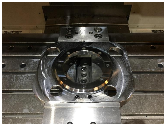
Slika 8.10 Čeono glodanje (izrada konture) [8]
