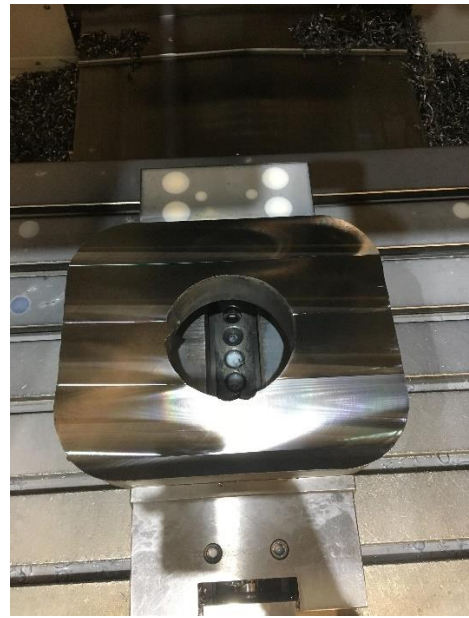
Slika 8.4 Čeono glodanje prednje strane [8]
