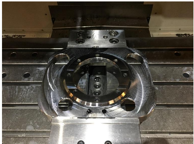
Slika 8.10 Čeono glodanje (izrada konture) [8]
