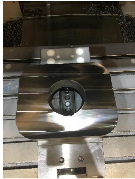
Slika 8.4 Čeono glodanje prednje strane [8]
