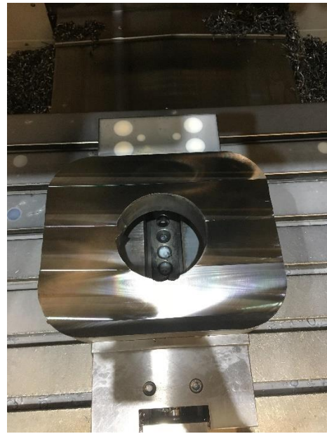
Slika 8.4 Čeono glodanje prednje strane [8]
