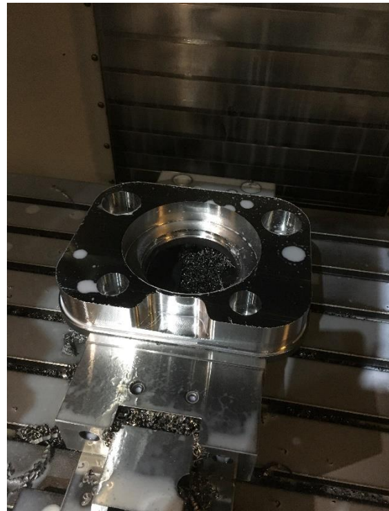
Slika 8.6 Glodanje vanjske konture [8]
