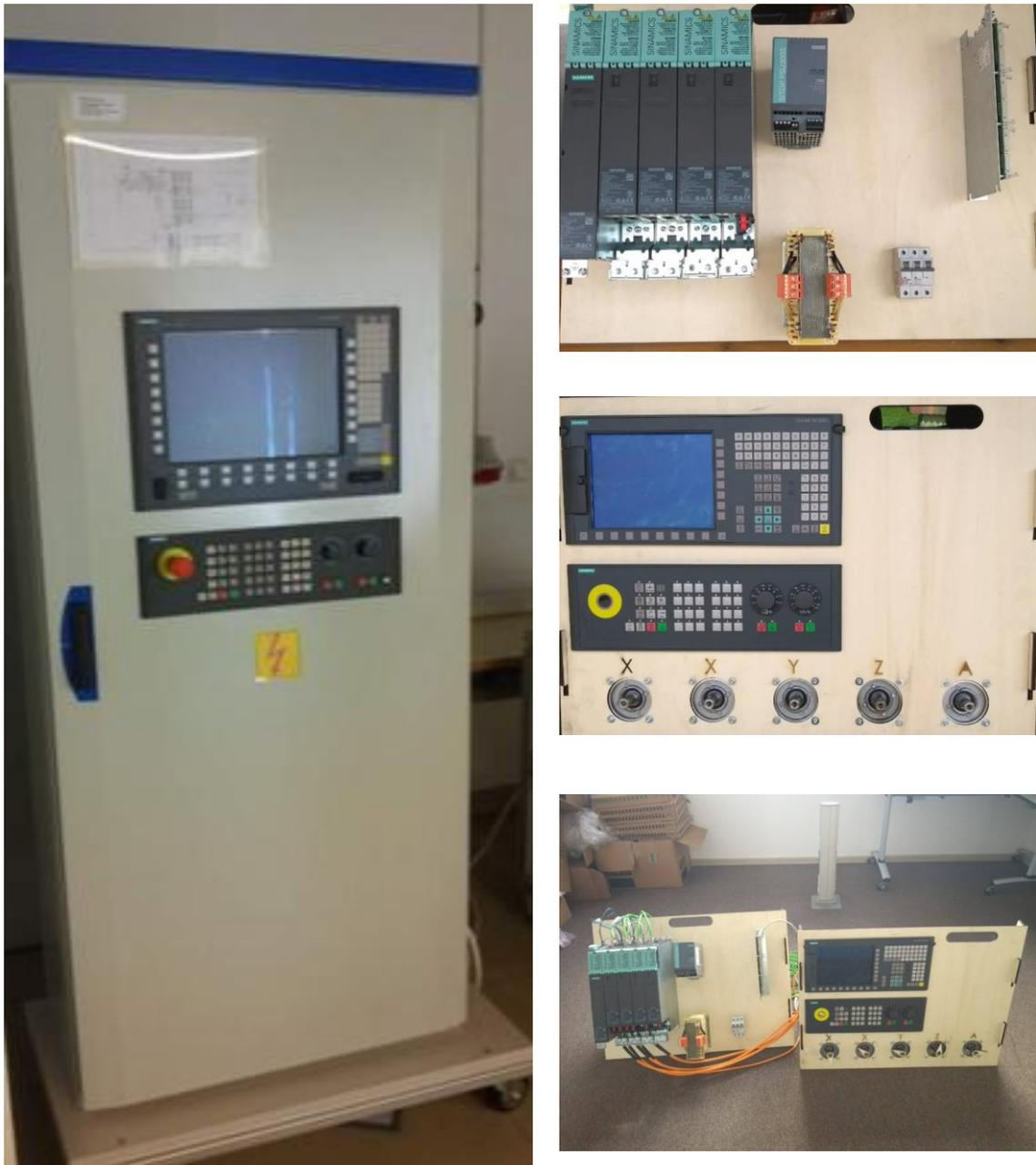
Slika 3.1 Upravljačka jedinica Sinumerik 840 Dsl {lijevo}[20] i Sinumerik 828D (desno) [22]
