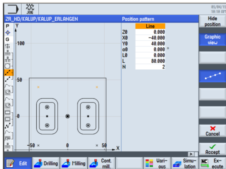
Slika 6.28. Definiranja pozicija rupa [4]
