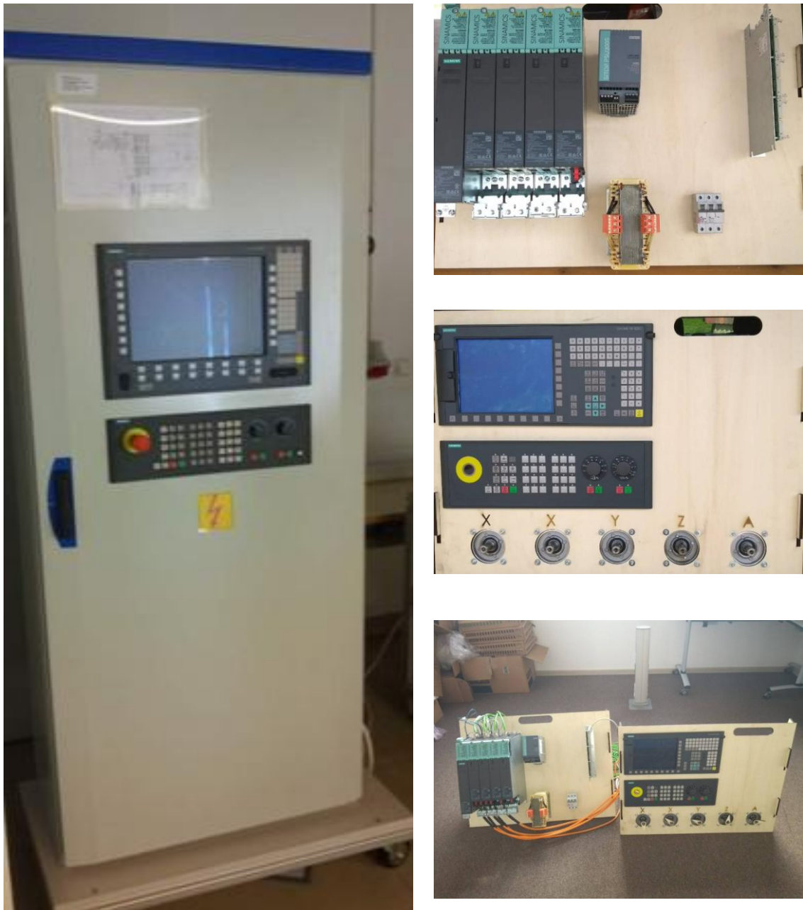
Slika 3.1 Upravljačka jedinica Sinumerik 840 Dsl {lijevo}[20] i Sinumerik 828D (desno) [22]
