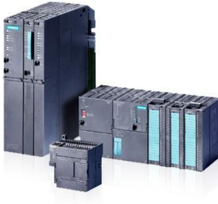
Slika 2.12. PLC Siemens serije 300 (integrirani CPU-317) [20]
