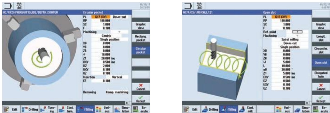
Slika 3.7. Tokarenje i glodanje – programGUIDE [1]
