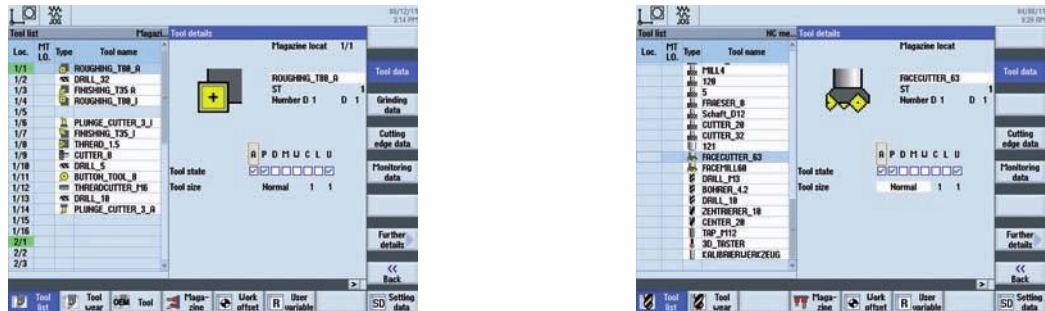
Slika 3.5. Sinumerik programsko sučelje za upravljanje alatima [1]
