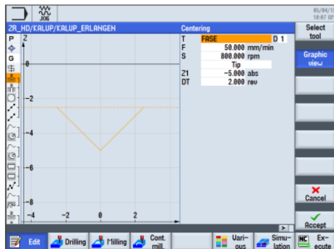
Slika 6.25. Postavljanje parametara za zabušivanje [4]
