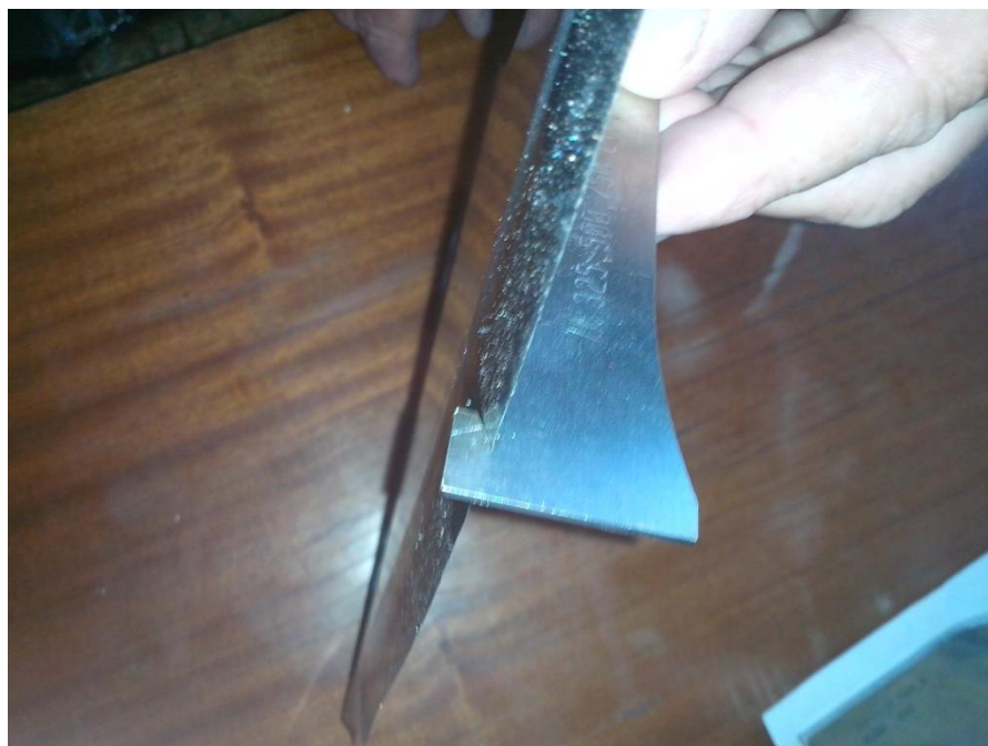
Slika 16. Provjera kuta oštrice [autorska]
