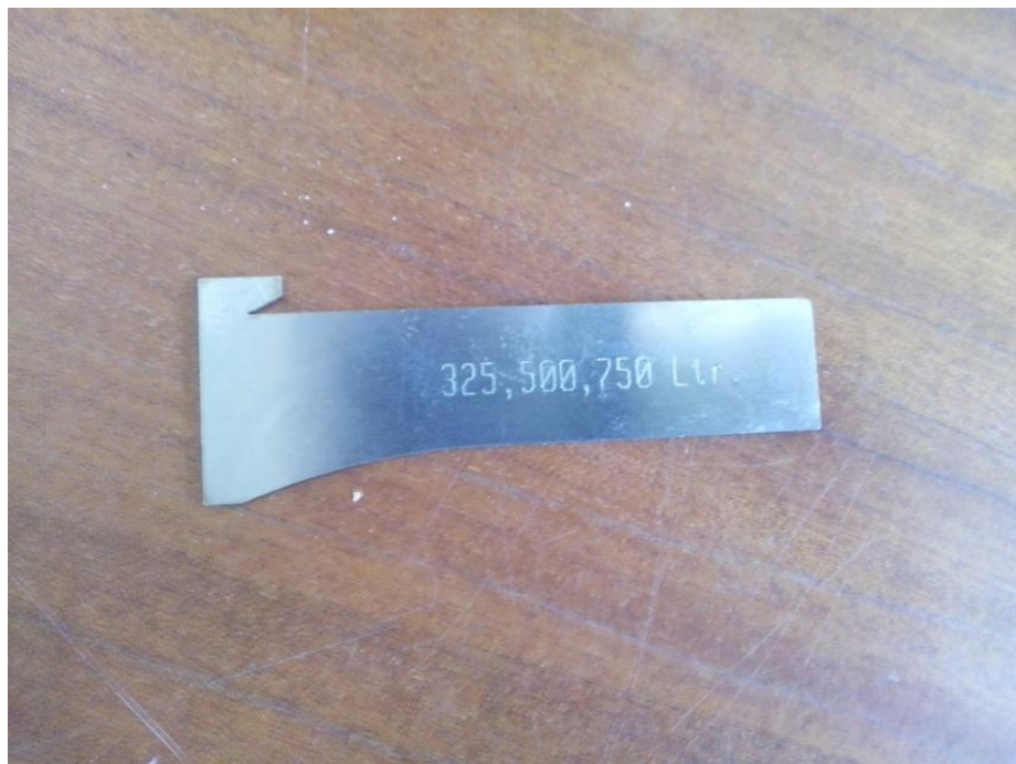
Slika 15. Etalon za provjeru kuta i radijusa oštrice [autorska]
