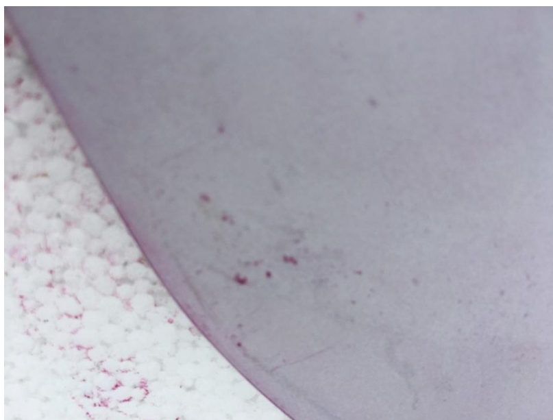
Slika 31. Uočene površinske nepravilnosti na oštrici uslijed nepravilnog poliranja [autorska]
