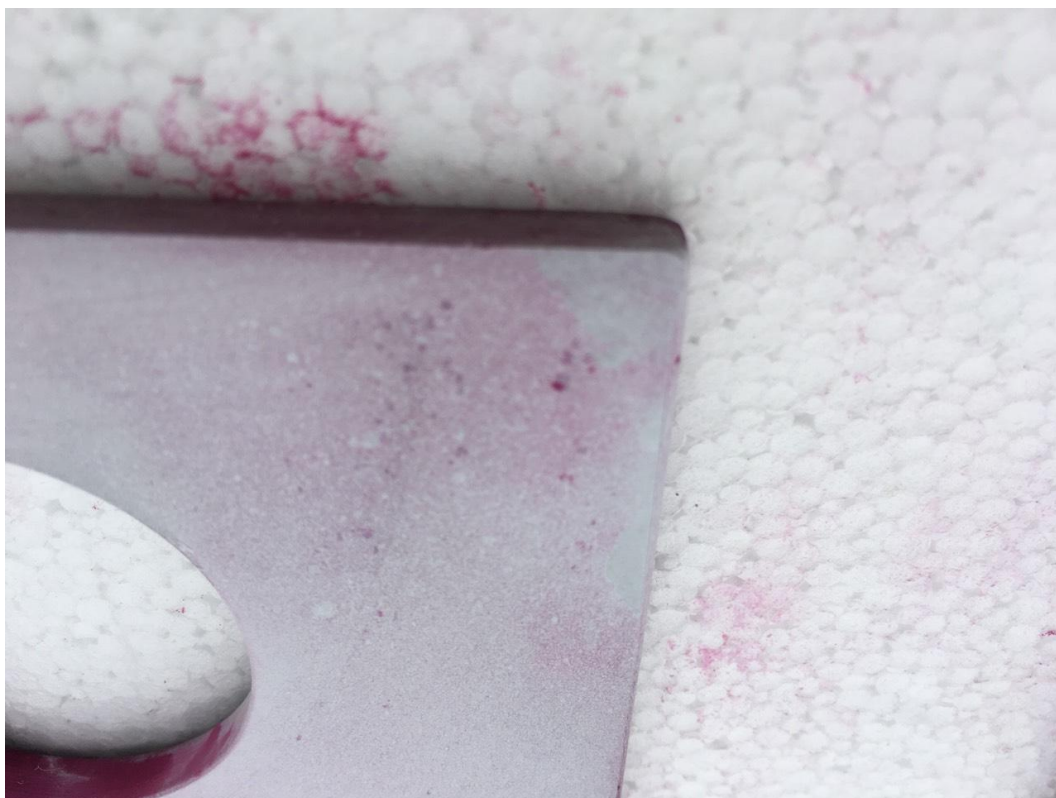
Slika 32. Uočene poroznosti materijala – pitting usijed eksploatacije [autorska]
