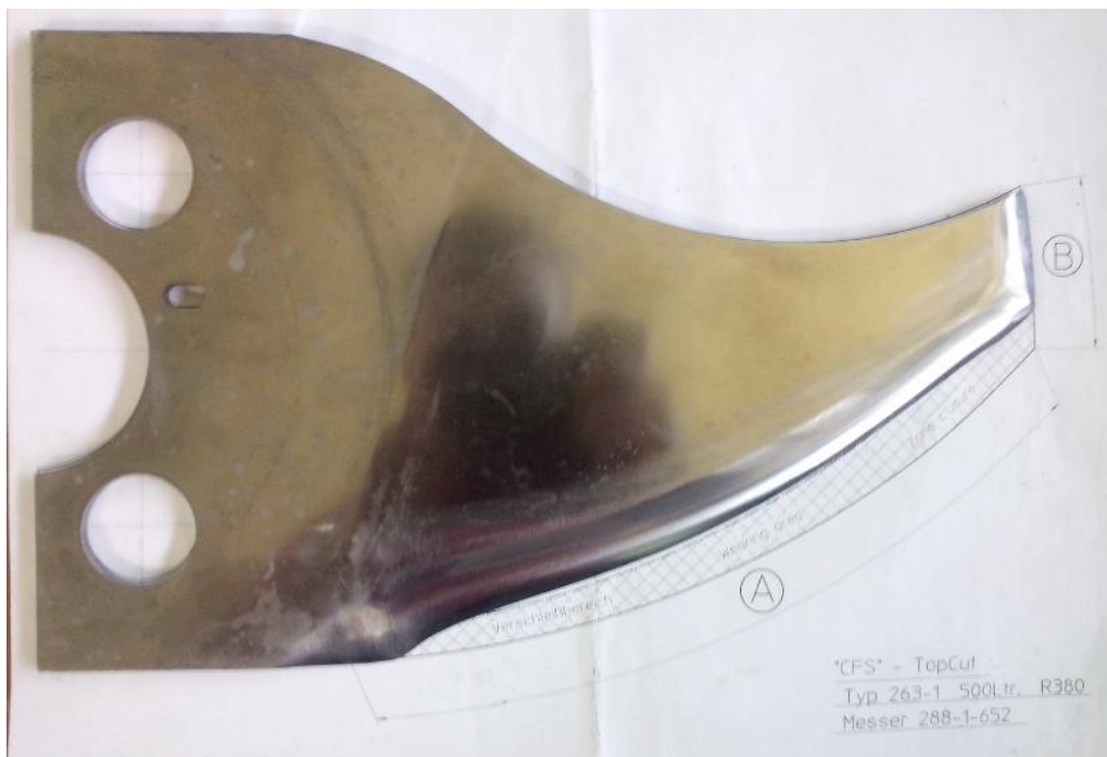
Slika 22. Neispravan nož – prebrušen [autorska]
