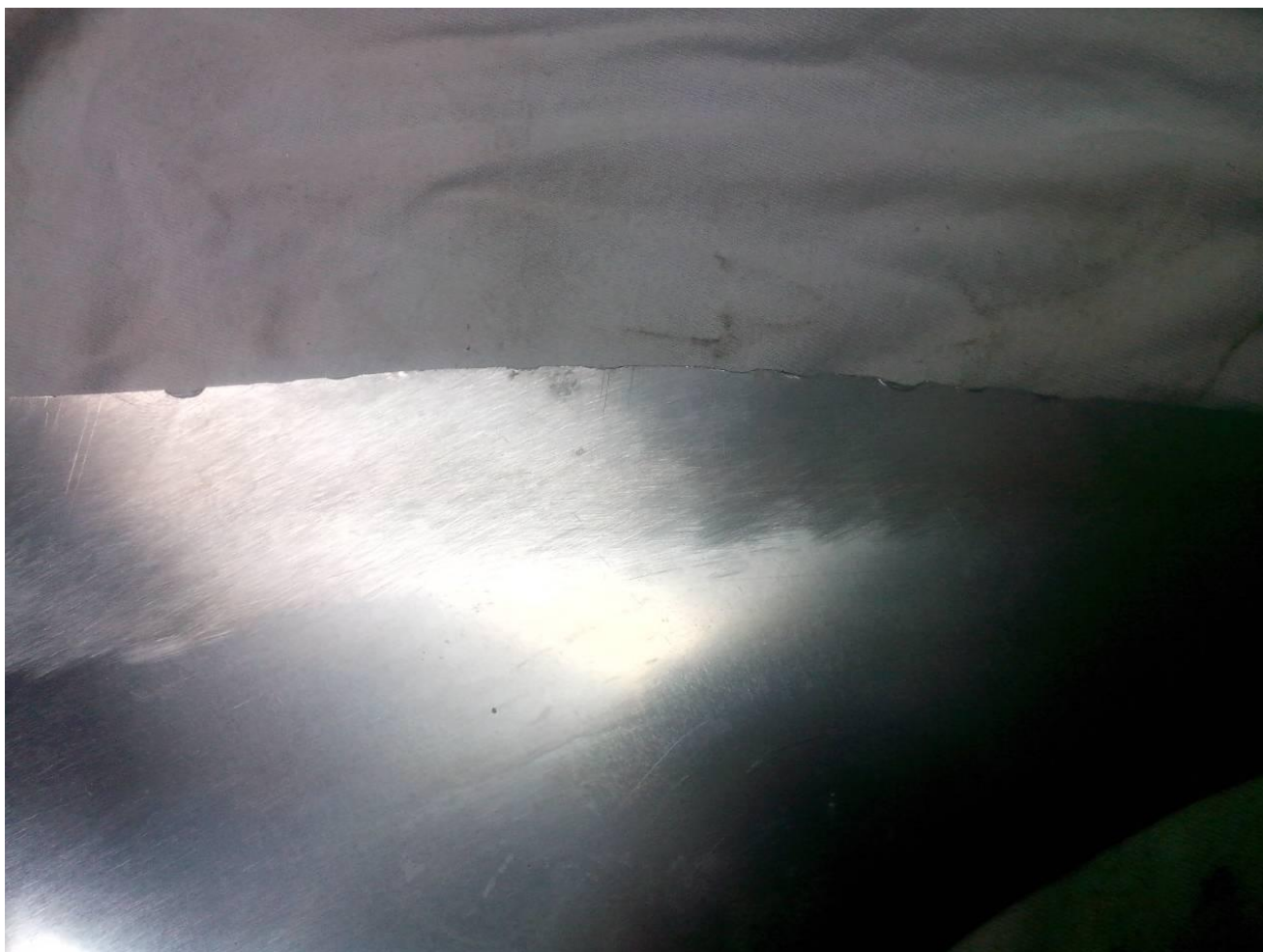
Slika 19. Oštećenje oštrice [autorska]
