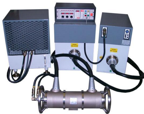
Slika 5. Standardna operama industrijskog aparata za ispitivanje x-zrakama [2]
