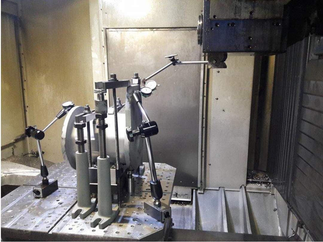
Slika 15. Pozicioniranje proizvoda na stroju prije strojne obrade
