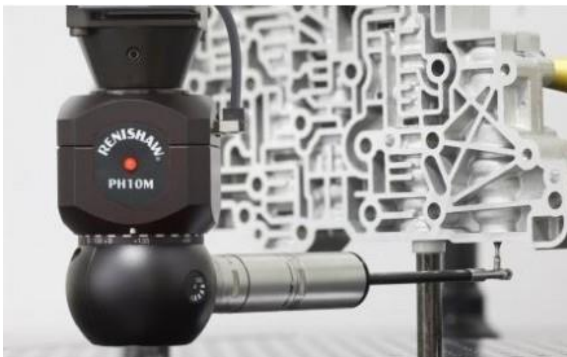
Slika 12. Motorizirana mjerna sonda [8]
