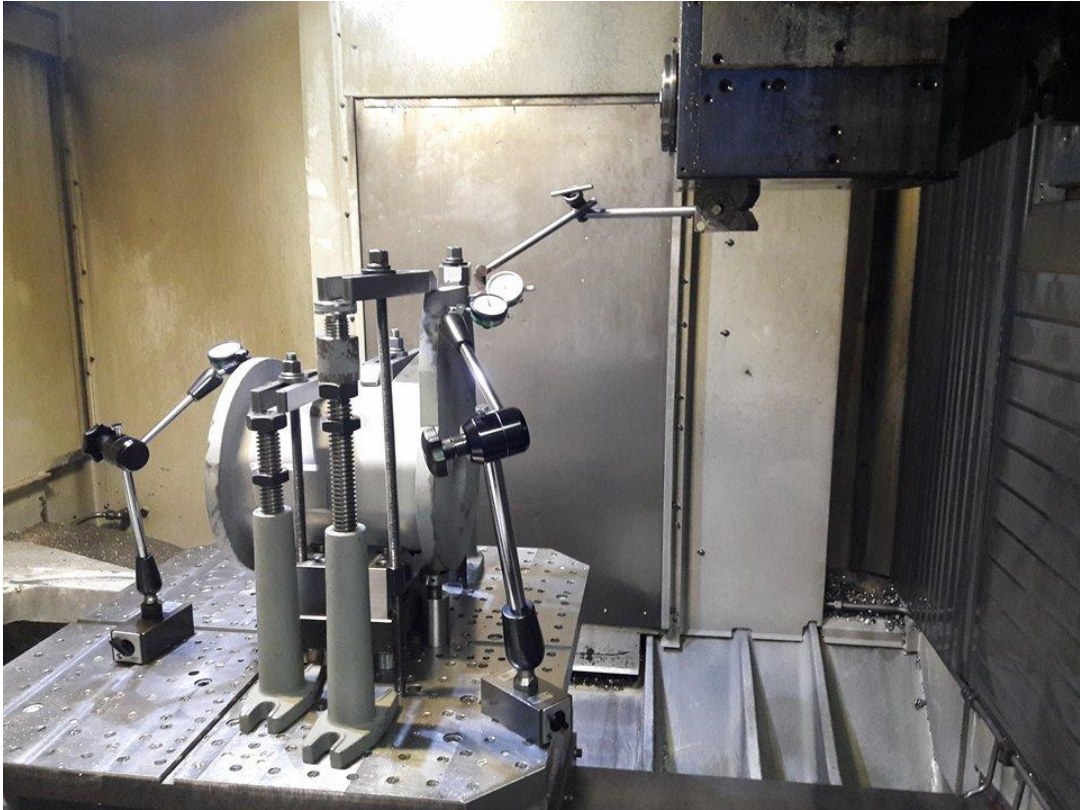
Slika 15. Pozicioniranje proizvoda na stroju prije strojne obrade
