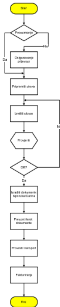
Slika 23. Dijagram toka transporta gotovih proizvoda
