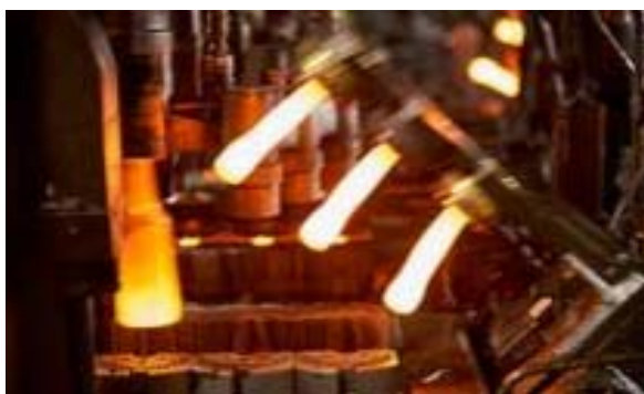
Slika 13. Proizvodnja (oblikovanje) staklene mase
