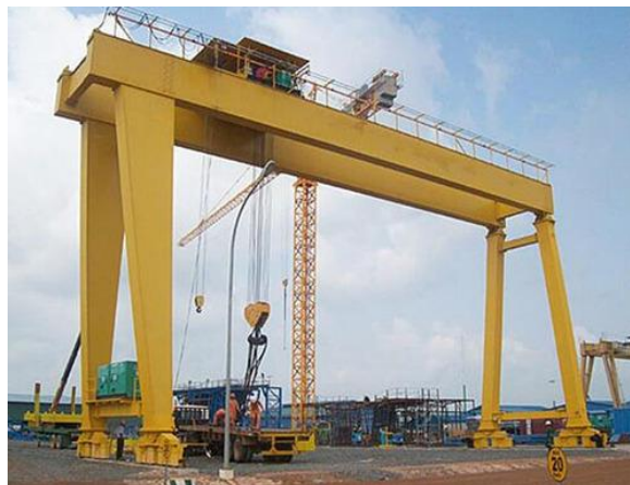
Slika 1.2. Velika stacionarna portalna dizalica za rad na otvorenom
