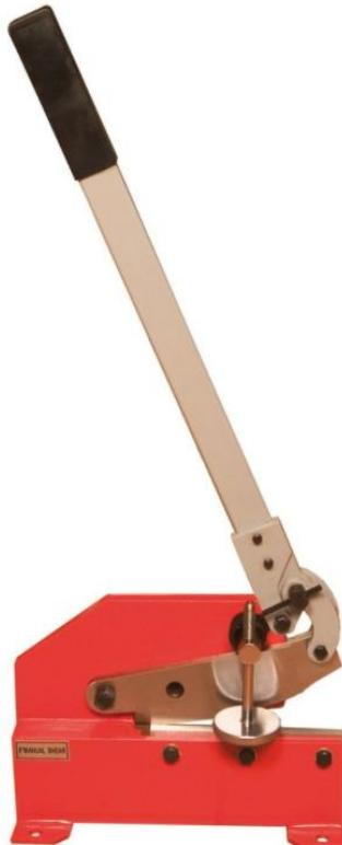
Slika 6.21: Škare za rezanje ploča [32]
