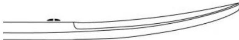
Slika 6.22: Prikaz zakrivljenih oštrica standardnih kirurških škara [35]
