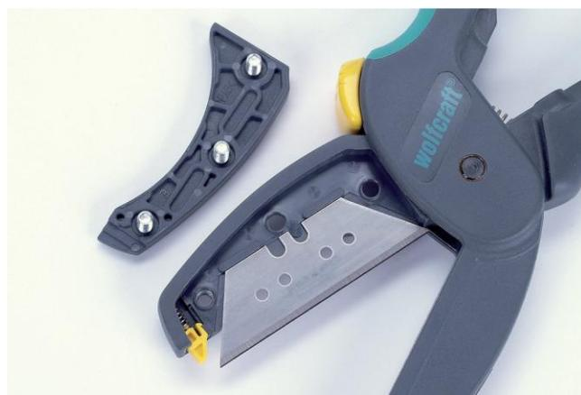
Slika 6.5 : Prikaz izmjenjive oštice [16]
