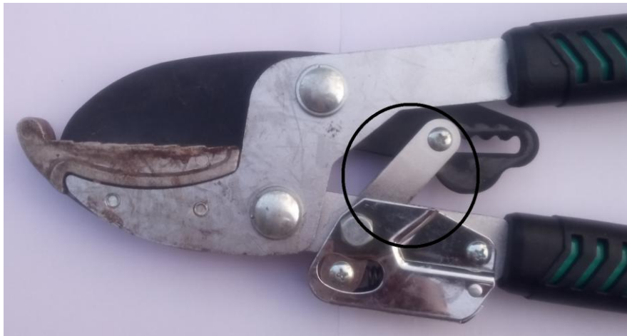
Slika 8.16: Prikaz polugice koja povezuje oštricu i ručku
