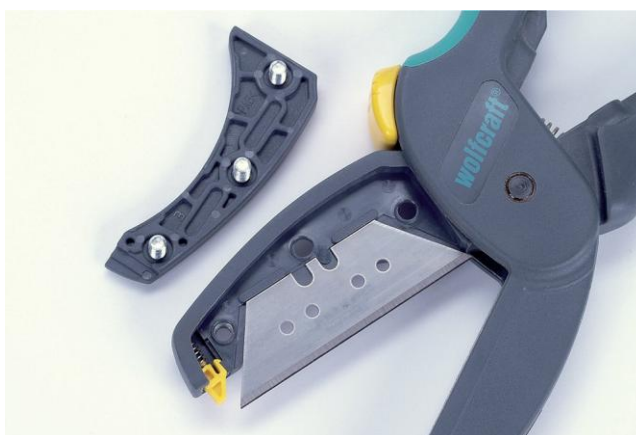
Slika 6.5 : Prikaz izmjenjive oštrice [16]
