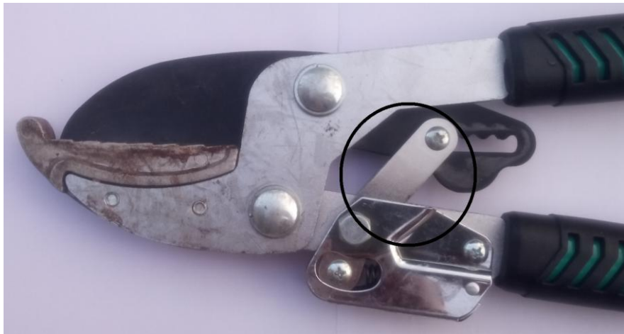
Slika 8.16: Prikaz polugice koja povezuje oštricu i ručku
