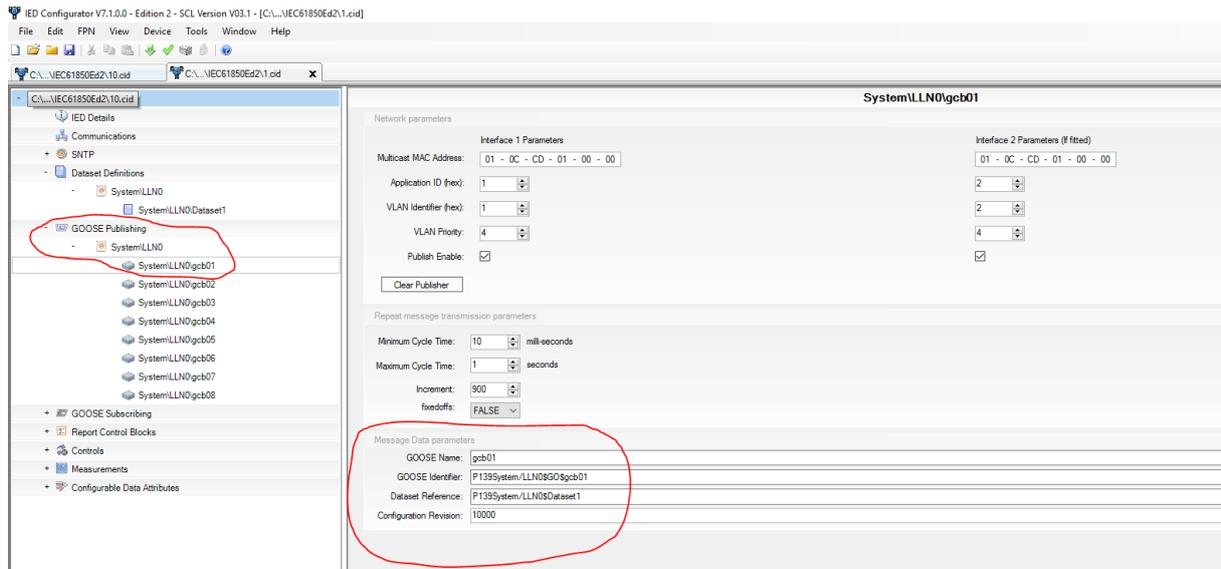
**Slika 11 Definiranje signala za slanje GOOSE poruke**
