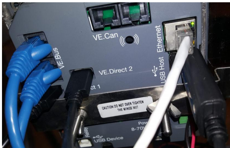
Slika 4.5 Prikaz povezivanja MultiPlus uređaja, DMC ploče i usmjerivač za internet
