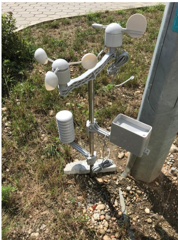
Slika 7.1: Vjetrostanica za mjerenje snage vjetra
