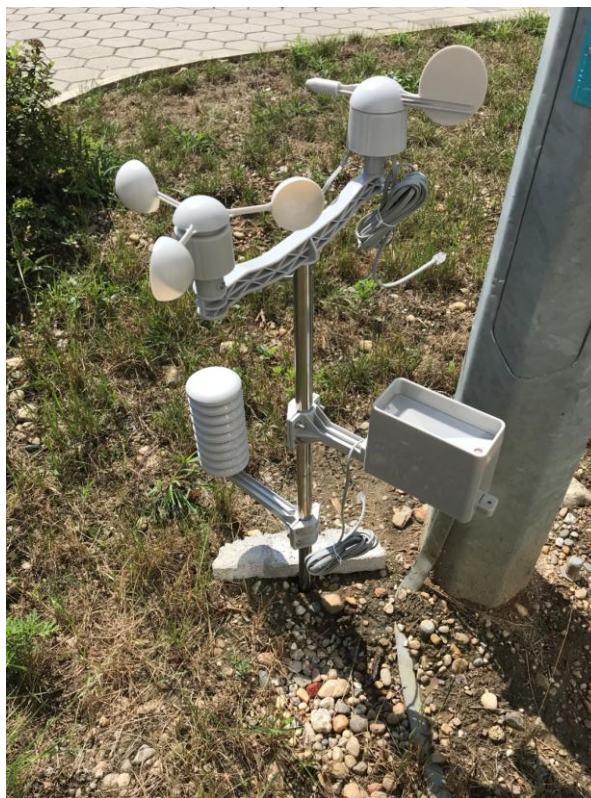
Slika 7.1: Vjetrostanica za mjerenje snage vjetra
