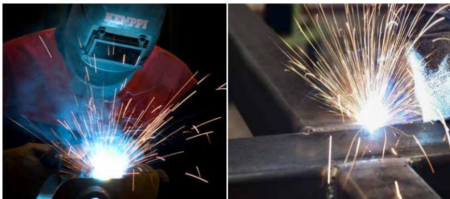
Slike 32 i 33. Zavarivanje Strenx-a[18]
