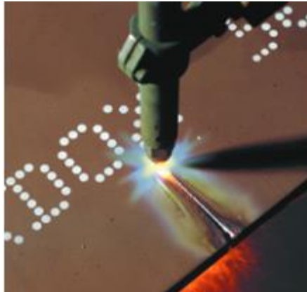
Slika 30. Plinsko rezanje Strenx čelika [18]
