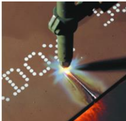
Slika 30. Plinsko rezanje Strenx čelika [18]
