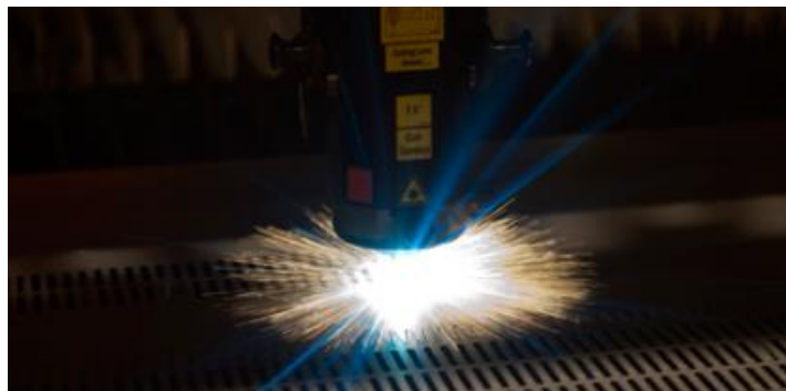
Slika 31. Rezanje laserom Strenx čelika [18]
