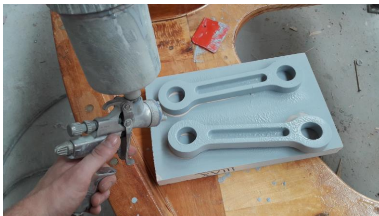
Slika 4.10 Nanošenje šprickita na model
