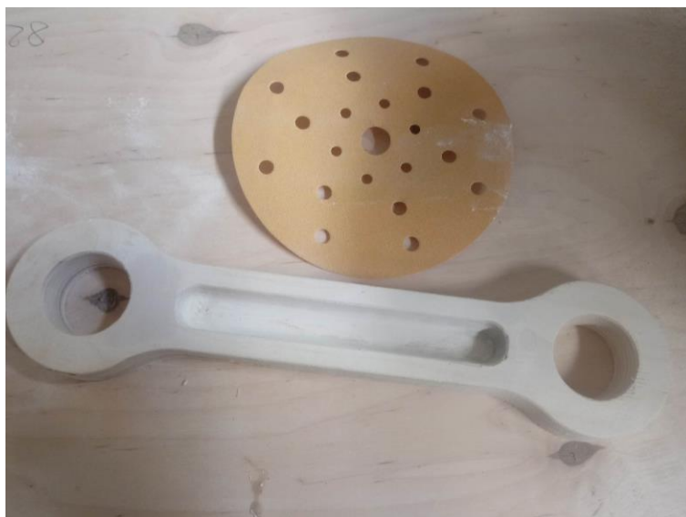
Slika 4.6 Model nakon grubog brušenja
