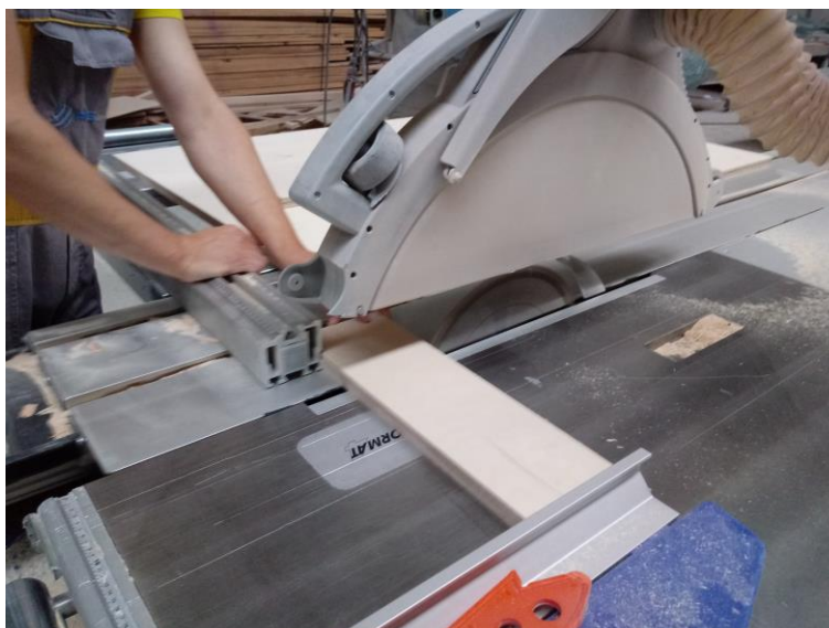
Slika 4.2 Izrezivanje ploča na kružnoj pili (cirkular)
