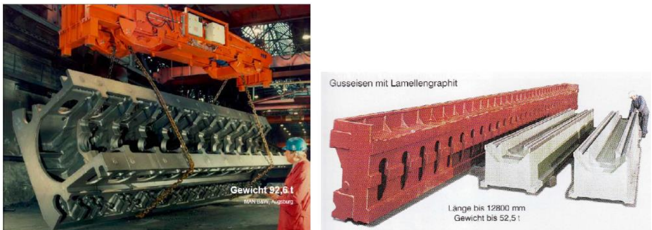
Slika 2.3 Blok brodskog diesel motora i postolja alatnih strojeva [2]
