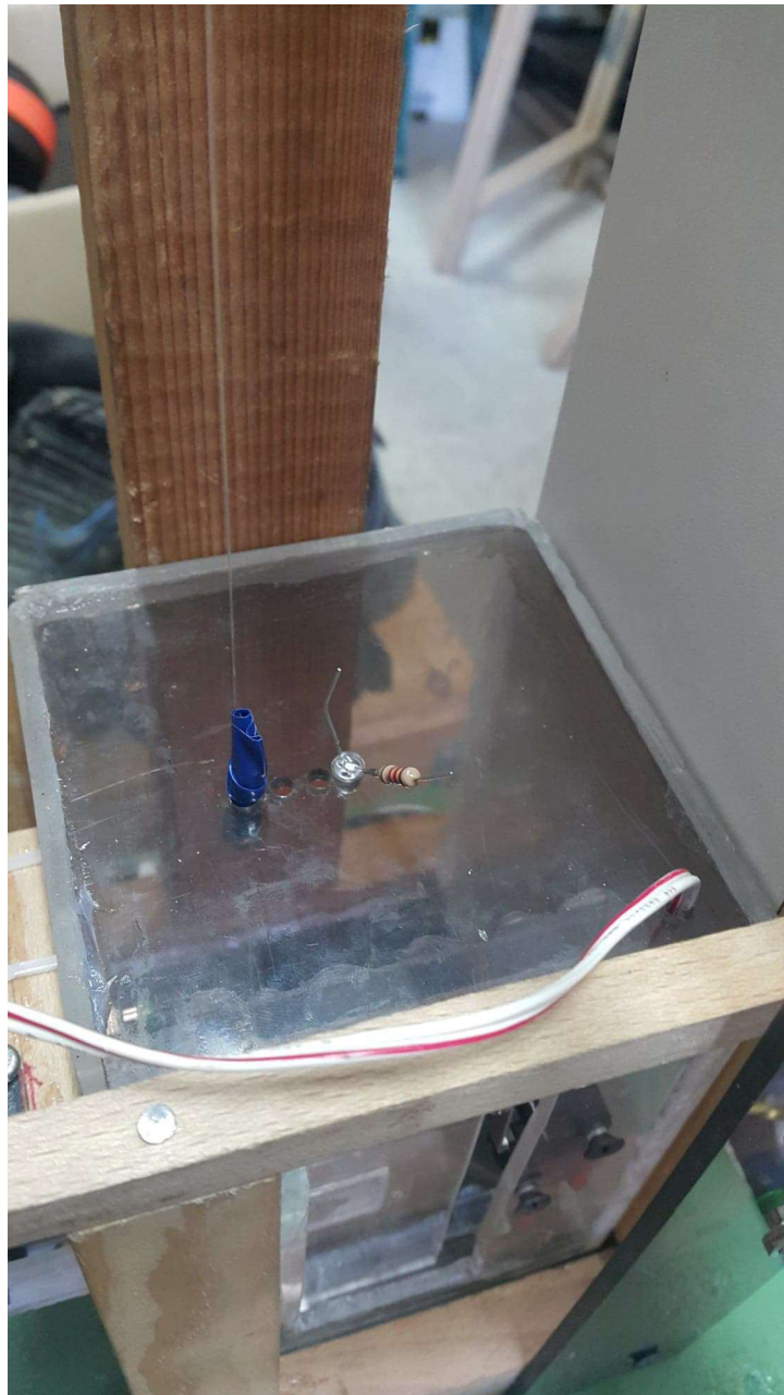
Slika 3.15. Postavljanje LED diode kao rasvjeta u dizalu
