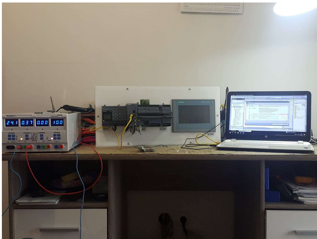
Slika 4.3. Prikaz PLC-a i HMI uređaja koji su spojeni na napajanje i računalo
