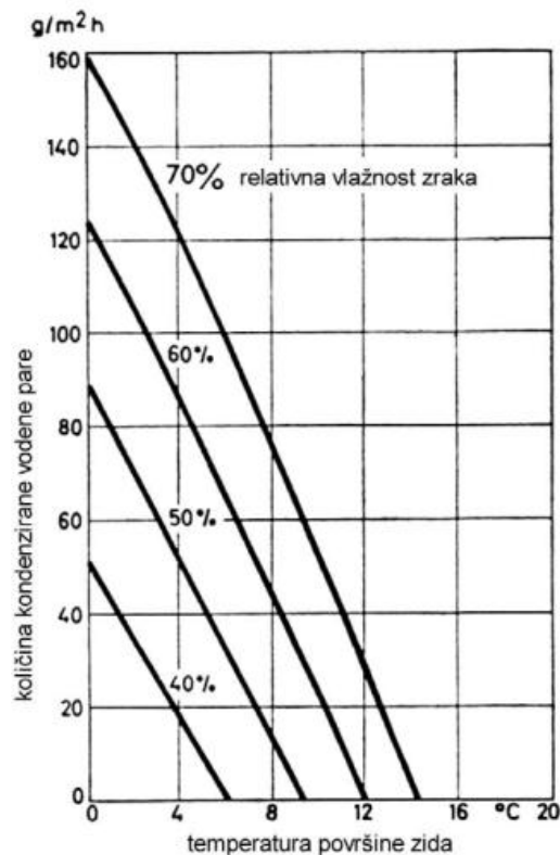
Slika 9. Prikaz relativne vlažnosti zraka pri temperaturi i količini kondenzirane vodene pare
