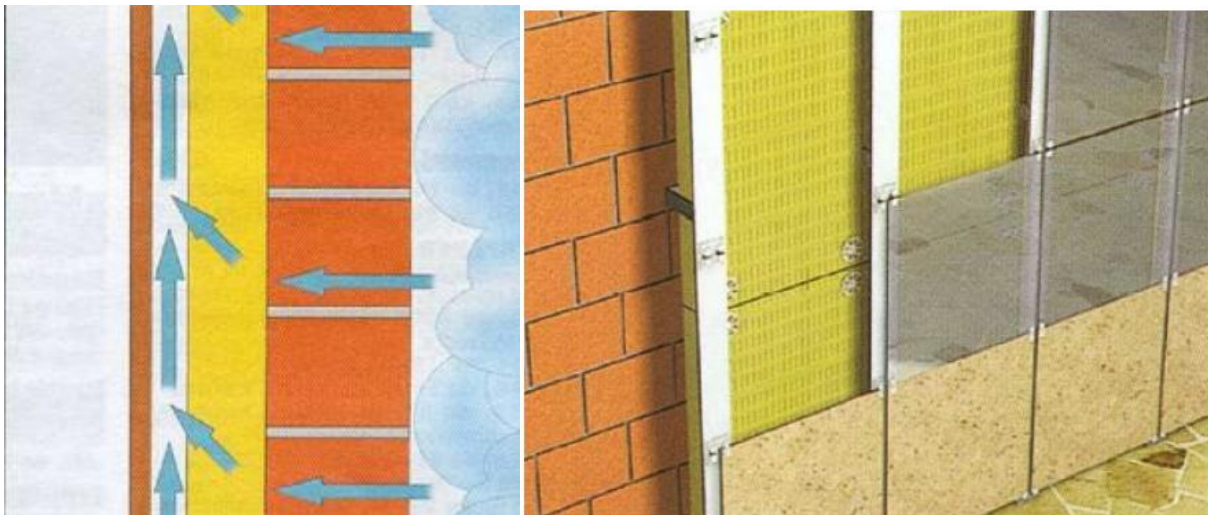
Slika 28., 29. Prikaz ventilirane fasade
