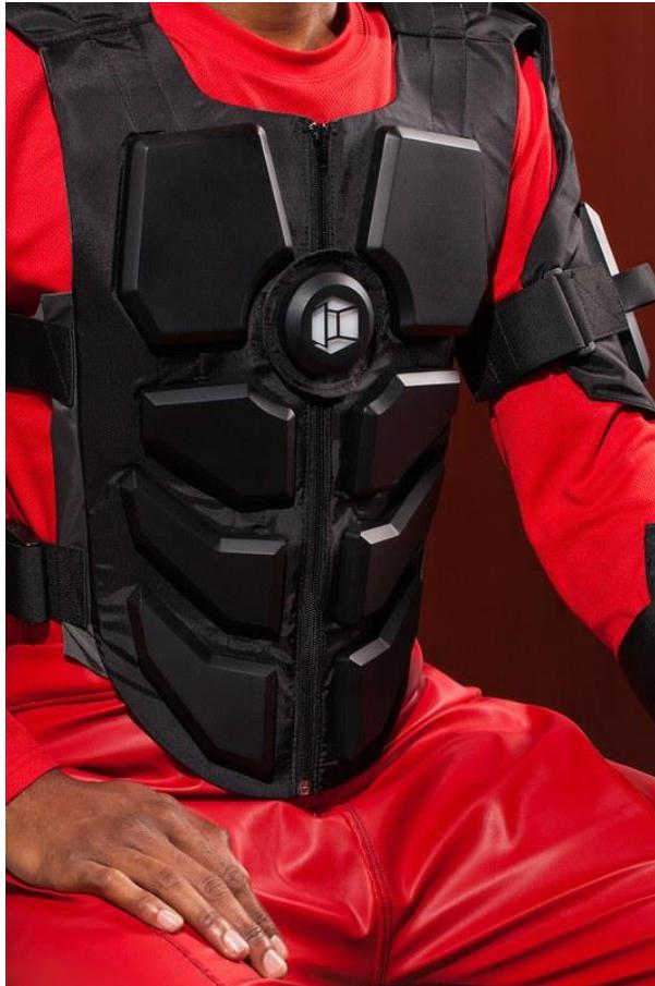
Slika 2.1.8. *Hardlight odijelo za simulaciju boli u virtualnoj stvarnosti*
