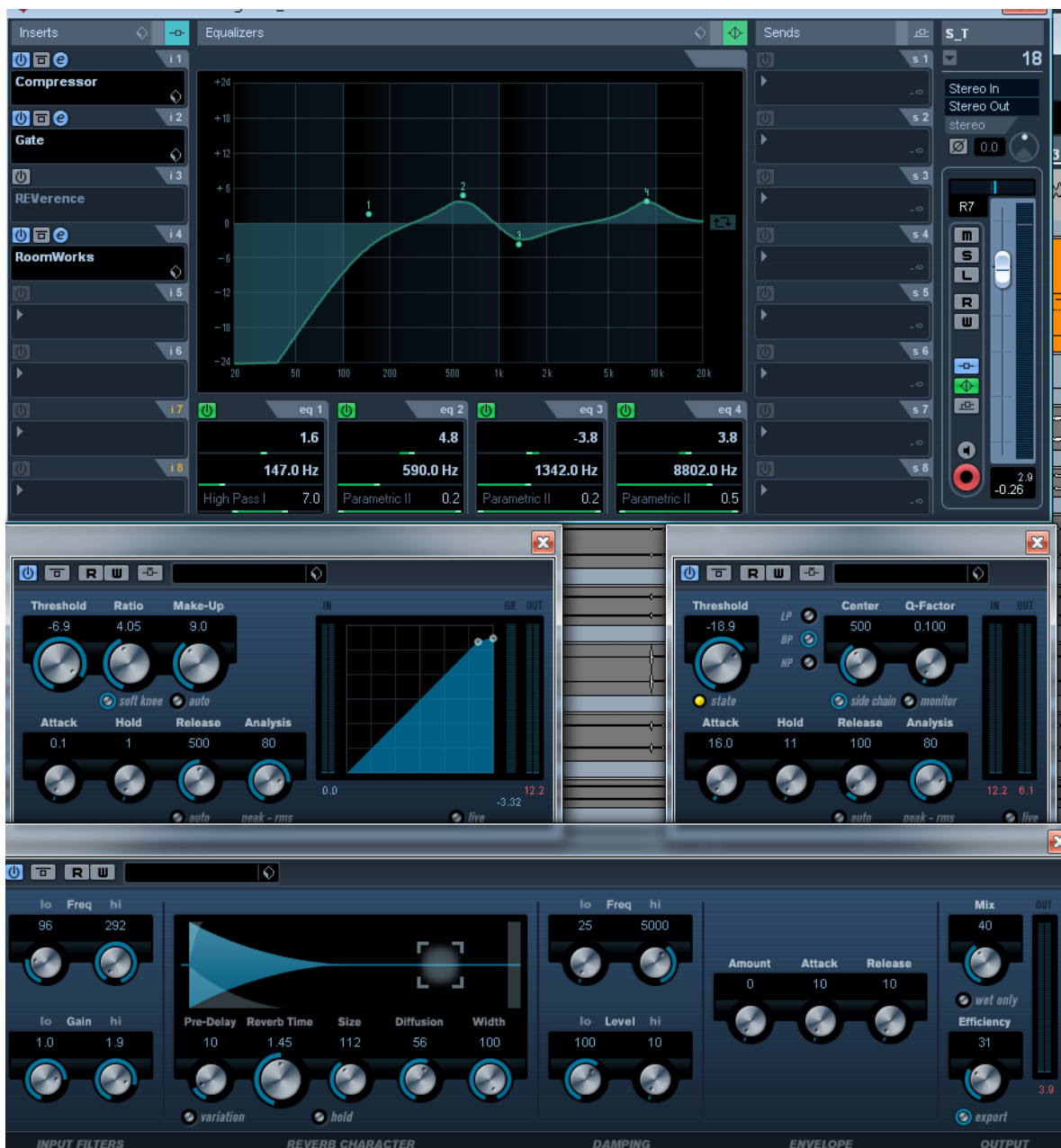
Slika 6.7 - Efekti gornjeg mikroфона doboša
