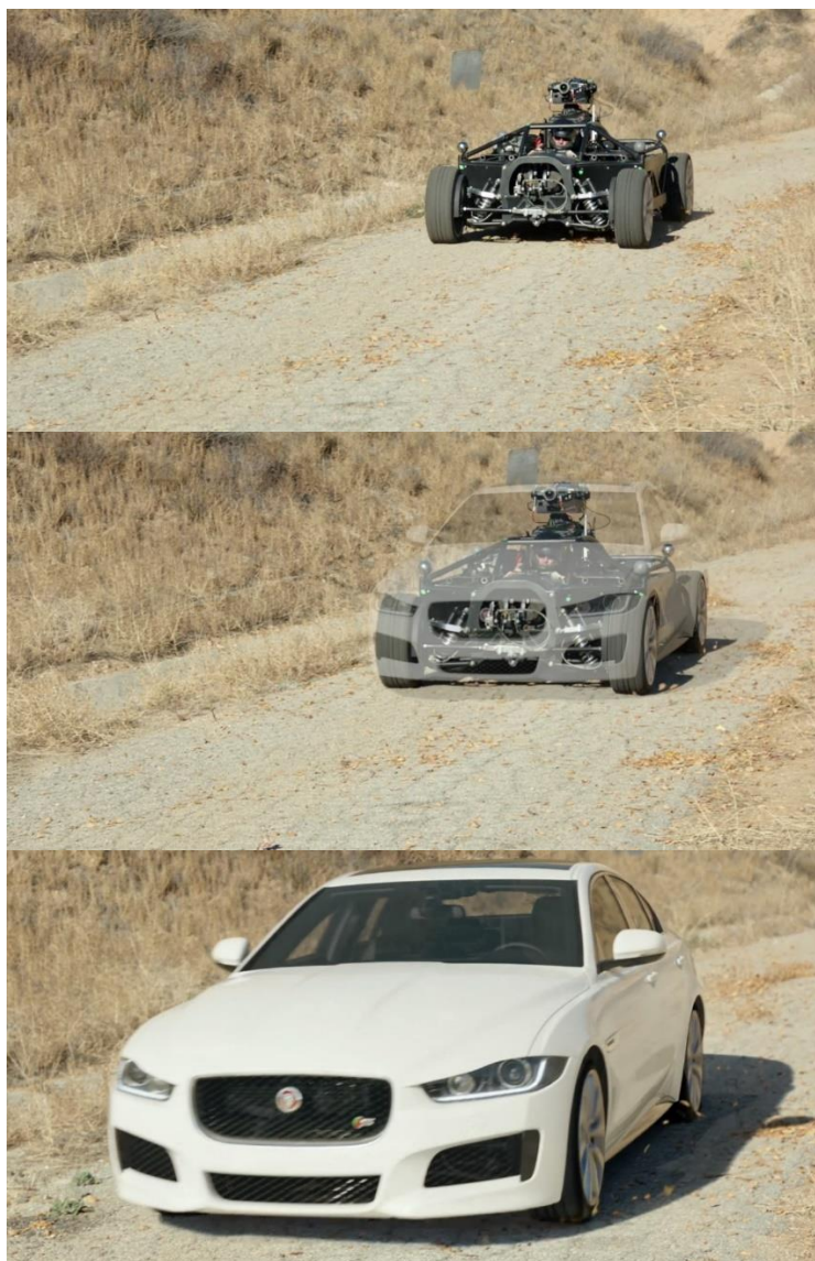
Slika 3.5 Proces produkcije videa pomoću automobila „The Blackbird“ [5]
