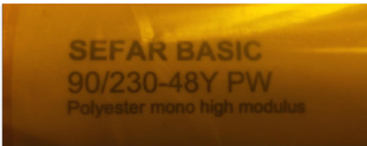
Slika 4.3.: Primjer standardizirane oznake na situ
