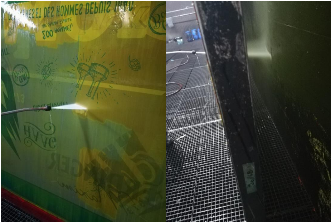
Slika 4.10.: Prikaz pranja prethodno nasnimanog dijela klišeja
