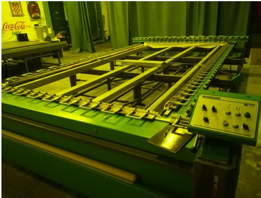
Slika 4.4.: Primjer stroja za rastezanje sita na okvir (Grunig G-Stretch 280)
