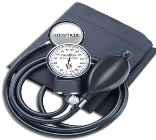
Slika 4.2.4. Aneroidni tlakomjer
