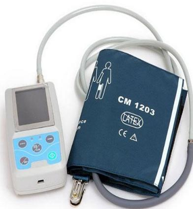
Slika 4.2.6. Uređaj za kontinuirano mjerjenje arterijskog tlaka (holter tlaka)
