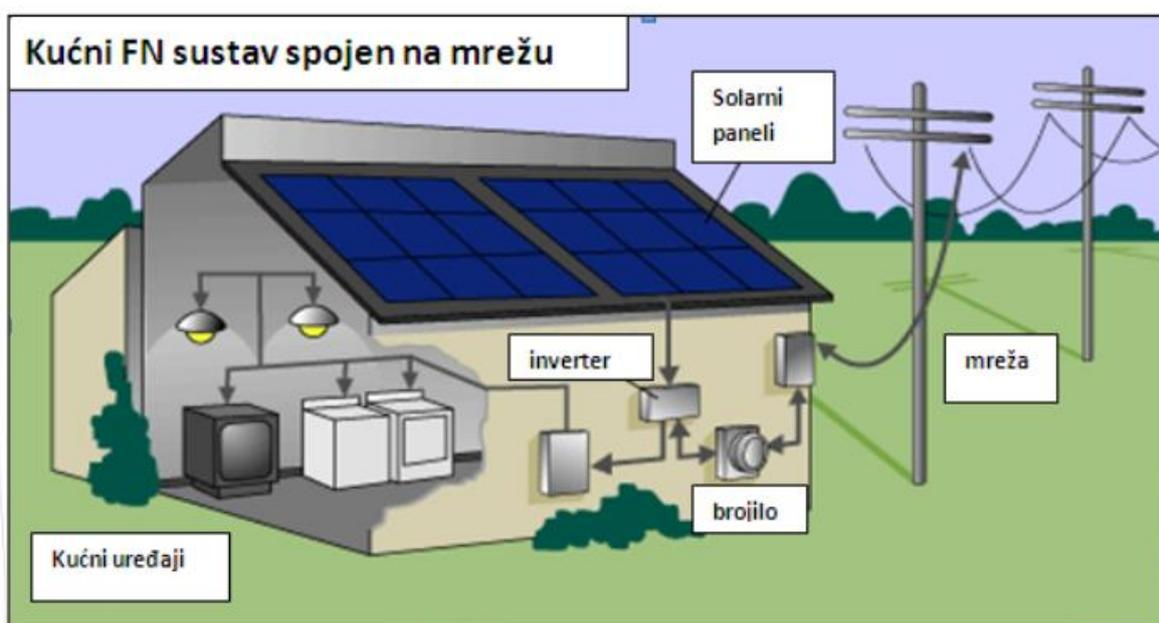
Slika 23. Kućni mrežni fotonaponaponski sustav
