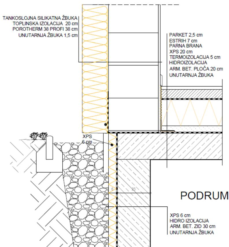
Slika 16. Detalj spoja vanjskog zida s pločom prizemlja
