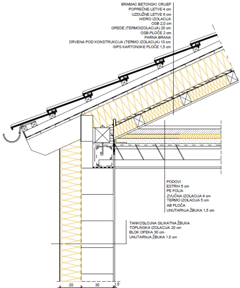
Slika 17. Detalj spoja vanjskog zida i krova
