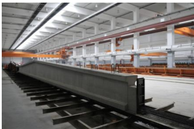
Slika 7. Odlagane glavnog nosača u tvornici za predgotovljene betonske elemente
