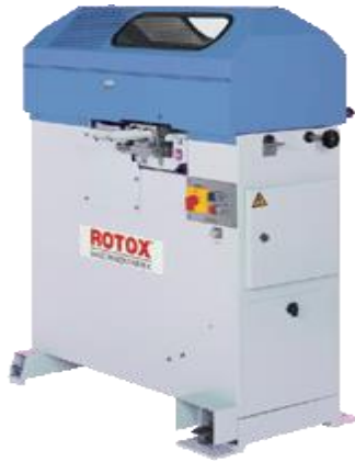
Slika 7. Pila letvica za staklo
