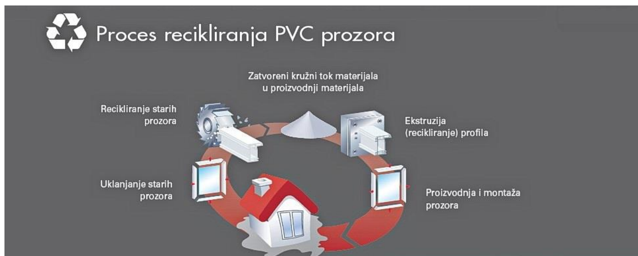
Slika 10. Primjer procesa recikliranja
