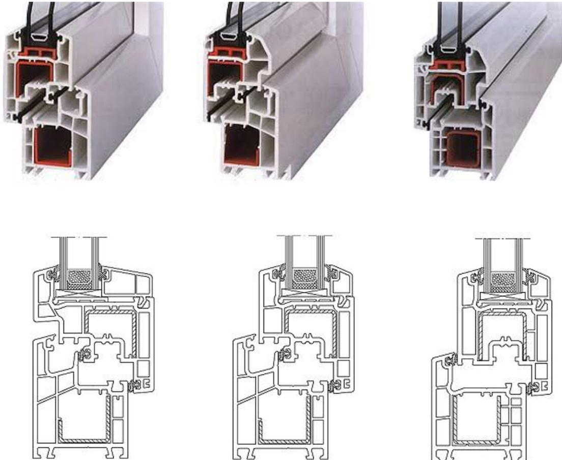
Slika 13. Primjer kvalitetnog 3-komornog sustava i presjek profila
