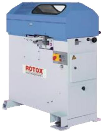
Slika 7. Pila letvica za staklo
