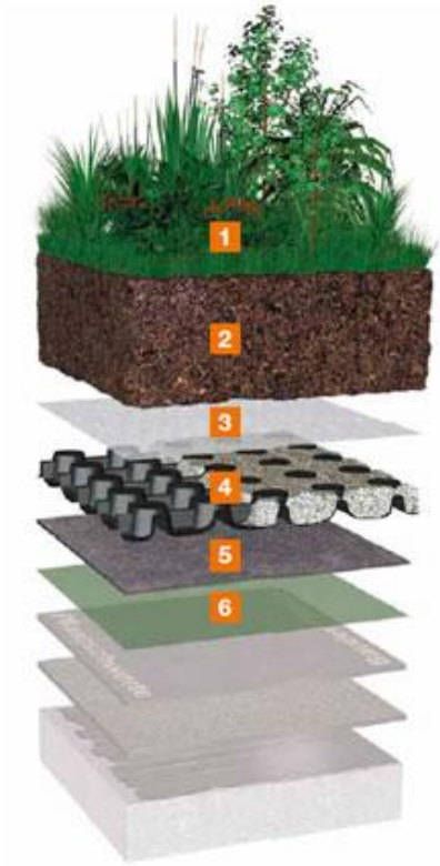
Slika 3.6. Slojevi intenzivnog zelenog krova Bauder
