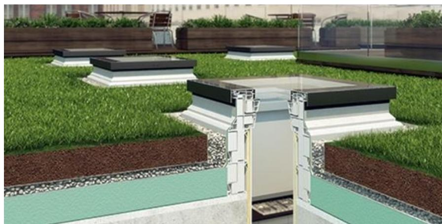
*Slika 3.11. Detalj svjetlosne kupole na zelenom krovu*
