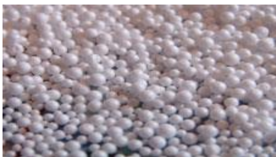
Slika 4. Ekspanirane „kokice“ od EPS
