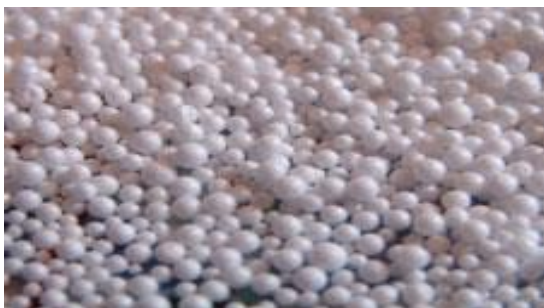
Slika 4. Ekspanirane „kokice“ od EPS
