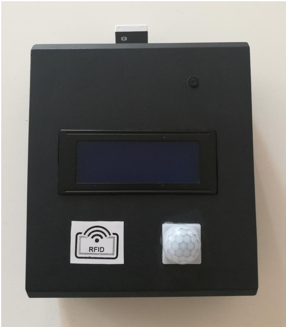
Slika 6.1. Maketa sustava za kontrolu pristupa
