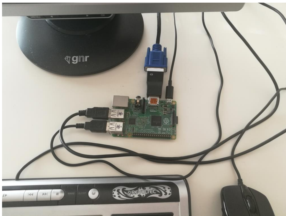
Slika 5.2. Spajanje Raspberry Pi računala
