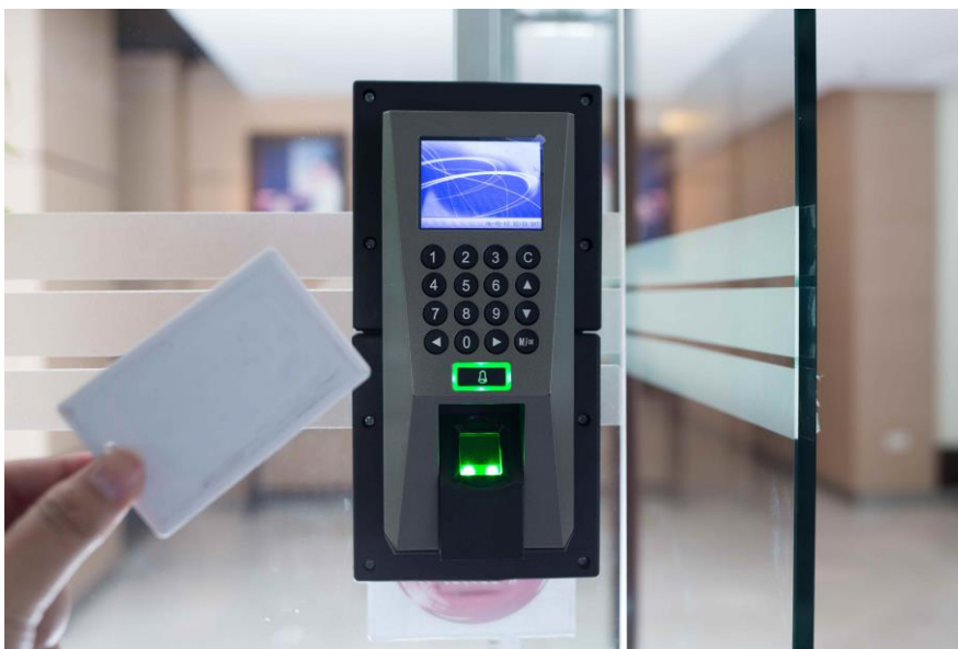
Slika 2.1. Sustav za kontrolu pristupa [1]
