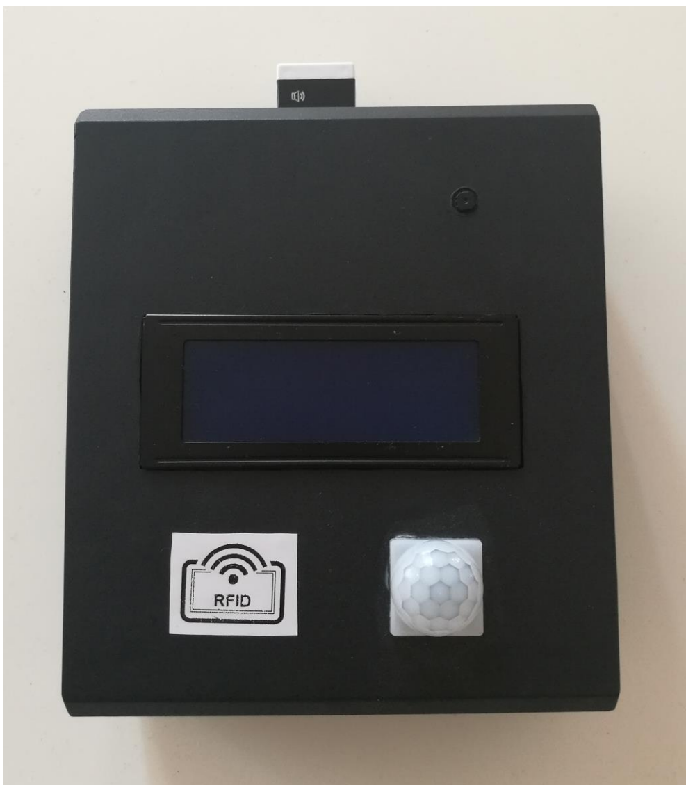
Slika 6.1. Maketa sustava za kontrolu pristupa
