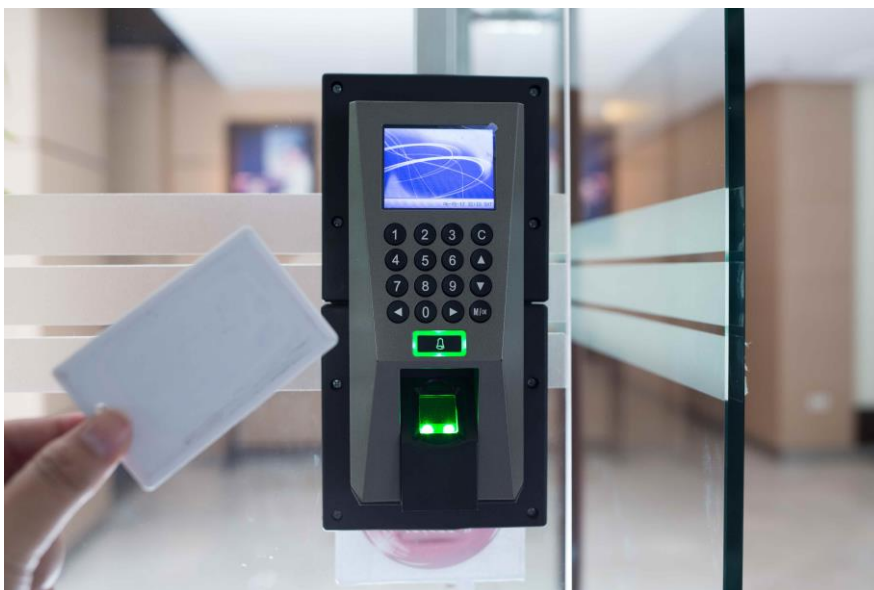
Slika 2.1. Sustav za kontrolu pristupa [1]
