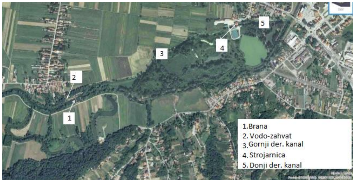
Slika 5. Kartografski prikaz glavnih dijelova postojeće hidroelektrane [21]
