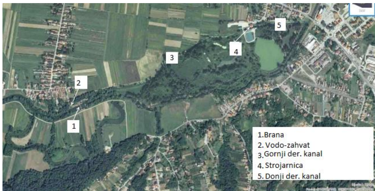
Slika 5. Kartografski prikaz glavnih dijelova postojeće hidroelektrane [21]
