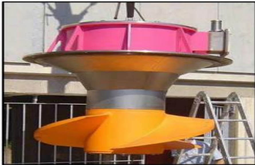
Slika 12. DIVE turbina spojena s generatorom u vodonepropusno kućište [21]
