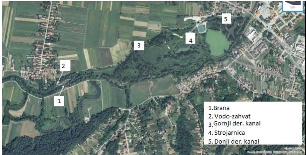
Slika 5.Kartografski prikaz glavnih dijelova postojeće hidroelektrane [21]
