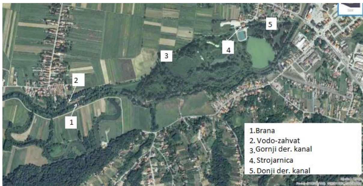
Slika 5. Kartografski prikaz glavnih dijelova postojeće hidroelektrane [21]
