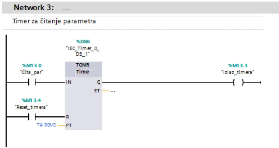
Korišten je blok za čitanje 5 parametra frekventnog ispravljača, a timer svakih 90 ms daje signal za čitanje parametra.
