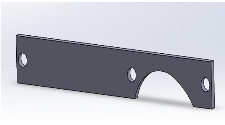
*Slika 3.6 3D model nosača kočnice*
