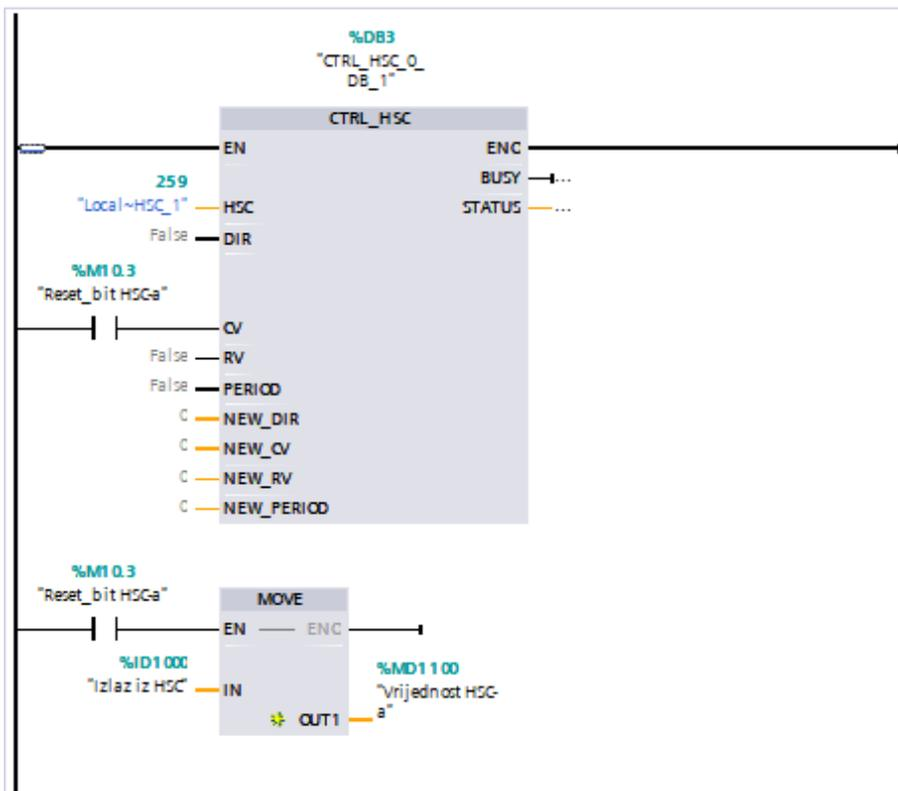
Brzi brojač se izvršava u prekidnoj rutini svakih 100 ms te se pri izlasku resetira na nulu. U ovom bloku je definiran brzi brojač HSC1 koji se nalazi na ulazu I0.0. Vrijednost brzog brojača se prebacuje u memorijsku lokaciju MD1100.
