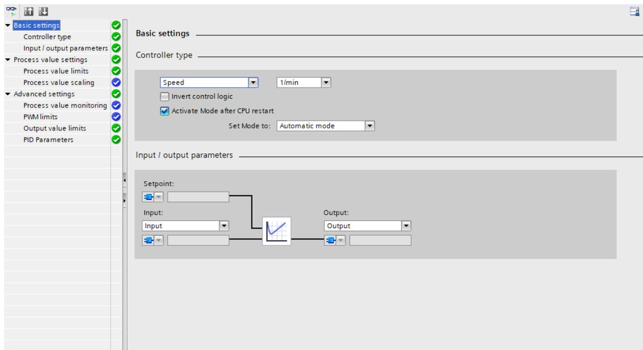
Slika 3.18 Konfiguracijski prozor PID\_Compact bloka (osnovne postavke)
