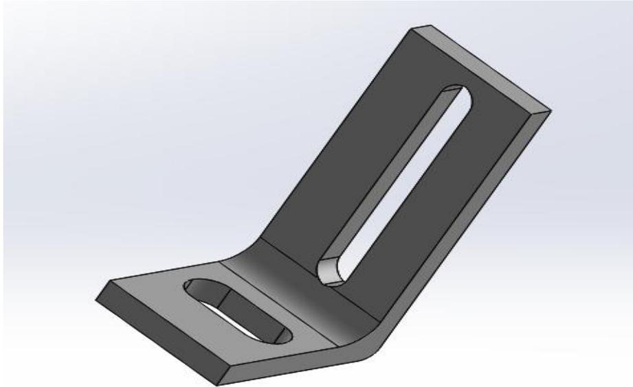
*Slika 3.2 Pogled na 3D model nosača senzora*
