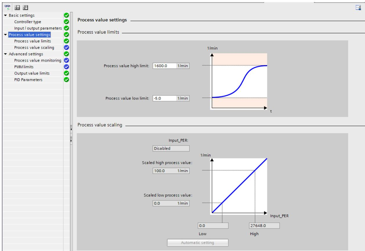
Slika 3.19 Konfiguracijski prozor PID\_Compact bloka (postavke procesne veličine)
