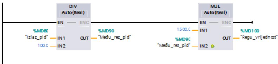
PID regulacija se odvija svakih 300 ms, a izlazna vrijednost se skalira i množi s 1500 da se dobije regulacijska vrijednost odnosno broj okretaja.
