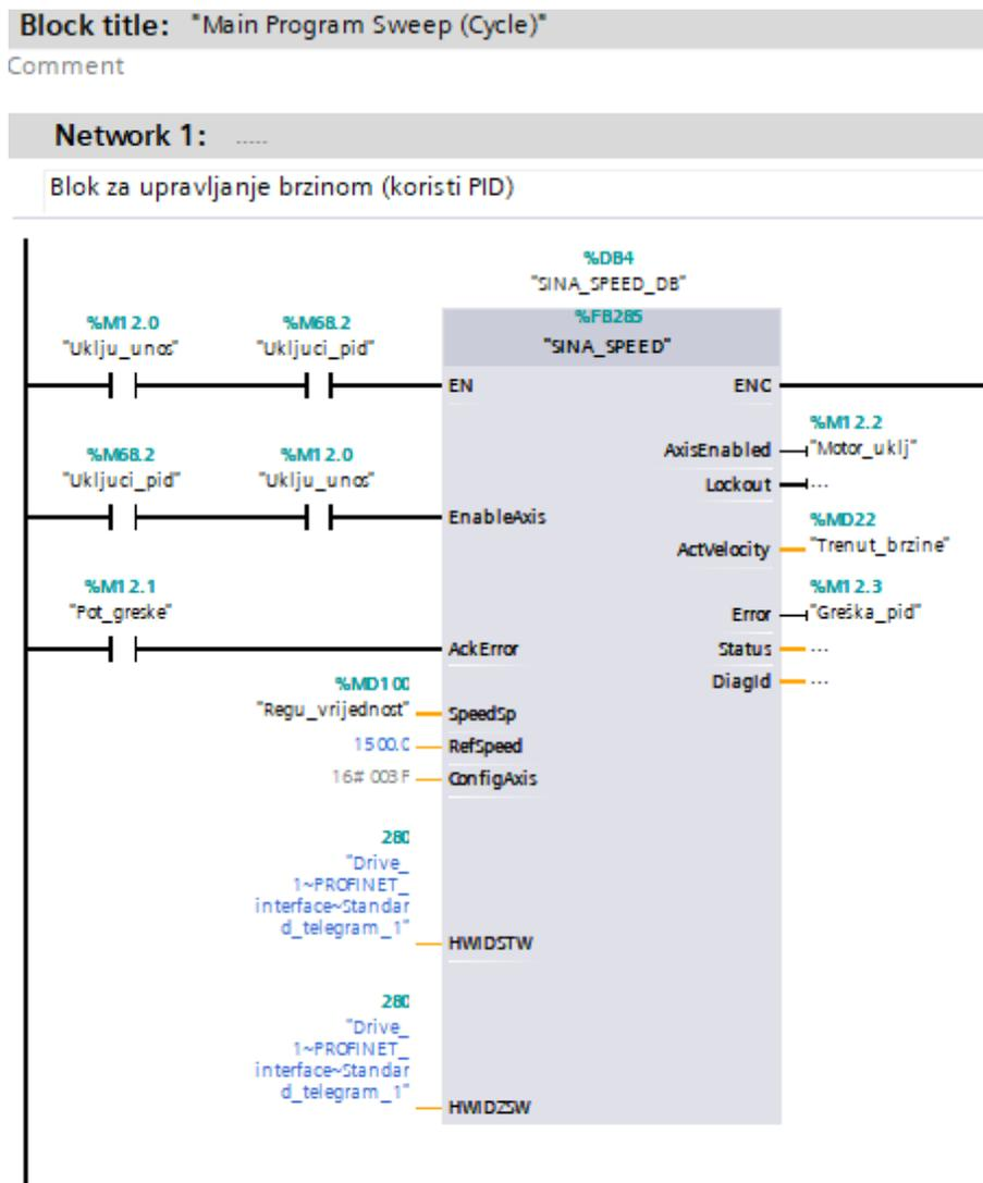
Ovaj blok služi za upravljanje brzinom kada je PID regulator uključen.
