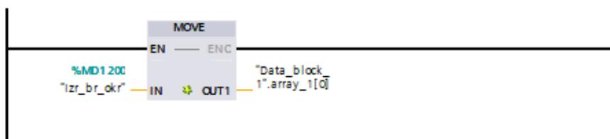
Množenjem broja impulsa s devetnaest dobiva se broj okretaja. Postavljen je bit za reset brzog brojača. Izračunati broj okretaja se sprema u polje (eng. *array*) na poziciju 0.
