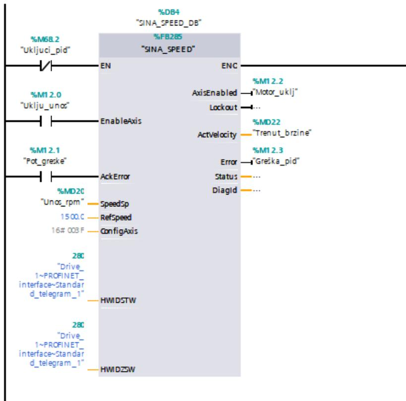
Ovaj blok služi za upravljanje brzinom bez PID regulacije. Unos broja okretaja se vrši preko dodirnog ekrana.
