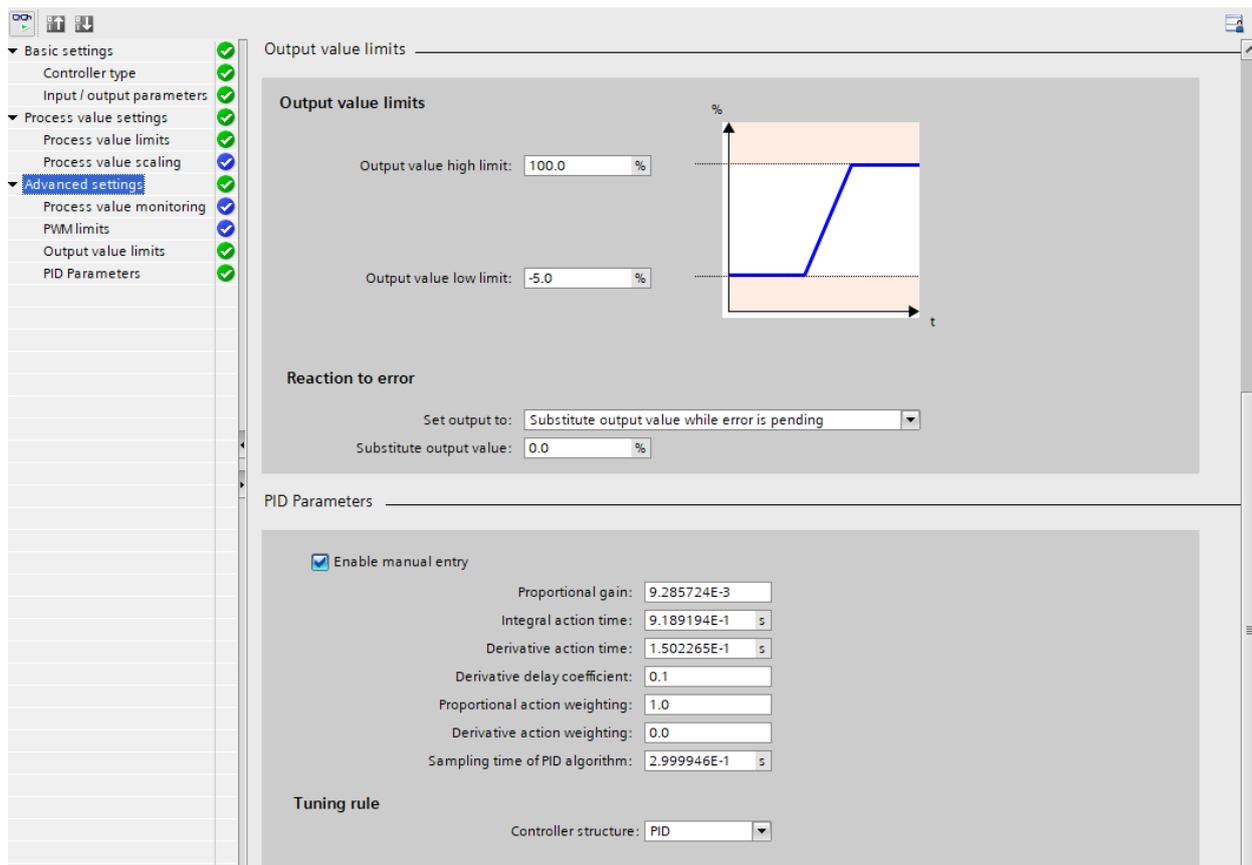
Slika 3.20 Konfiguracijski prozor PID\_Compact bloka (napredne postavke)
