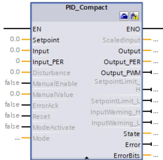
Slika 3.15 PID\_Compact blok [5]
