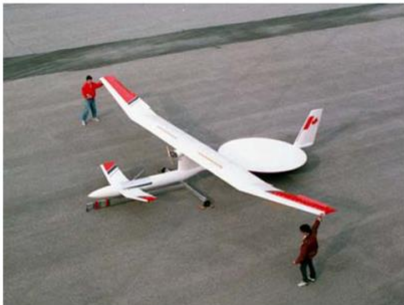
Slika 2.1 SHARP-ov avion koji je napajan mikrovalovima [4]
