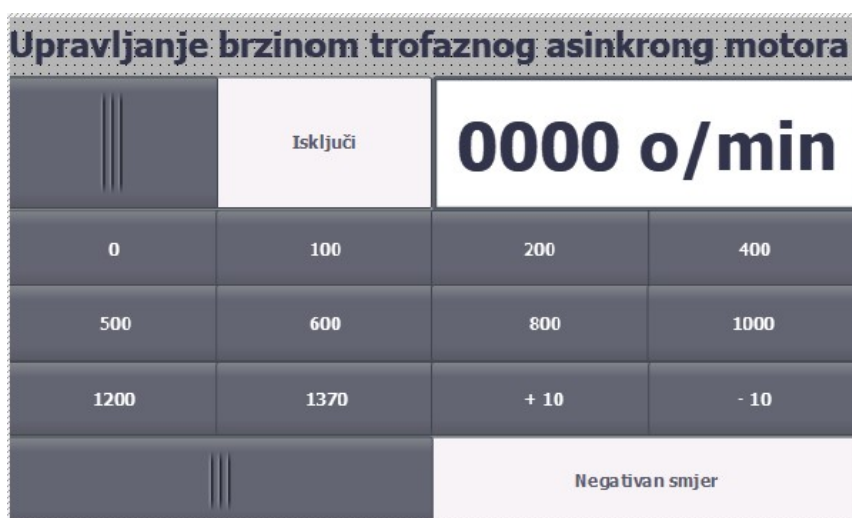
Slika 6.6 Izgled preko HMI panela
