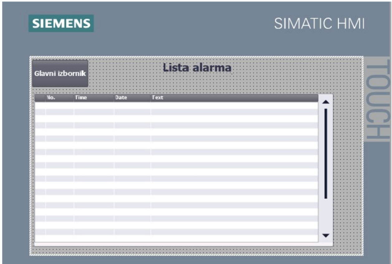
Slika 7.2. Prikaz ekrana „Alarmi“ u TIA portalu
