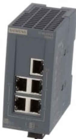
Slika 5.4 Kućište SIEMENS SCALANCE XB005
