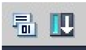
Slika 5.2 Izgled naredbi lijevo „Compile“ i desno „Download to device“
