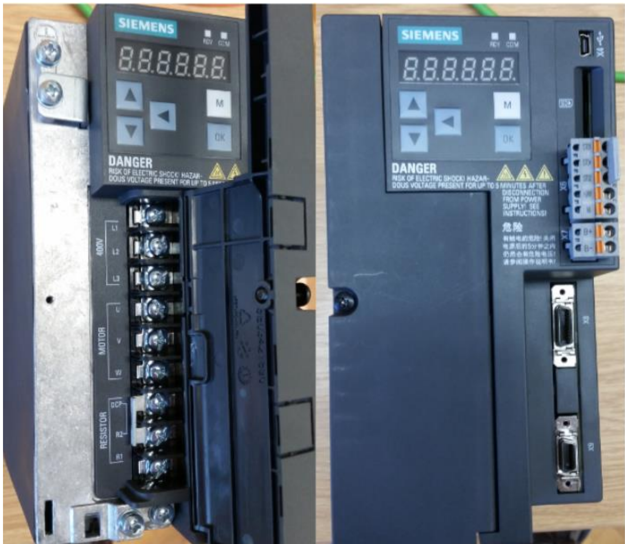
Slika 4.6 Siemens SINAMICS V90 servo driver
