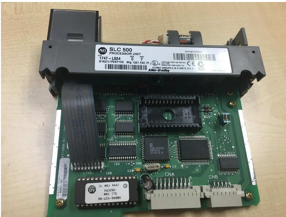
Slika 2.4 Primjer CPU-a ALLEN BRADLEY SLC 500 [13]
